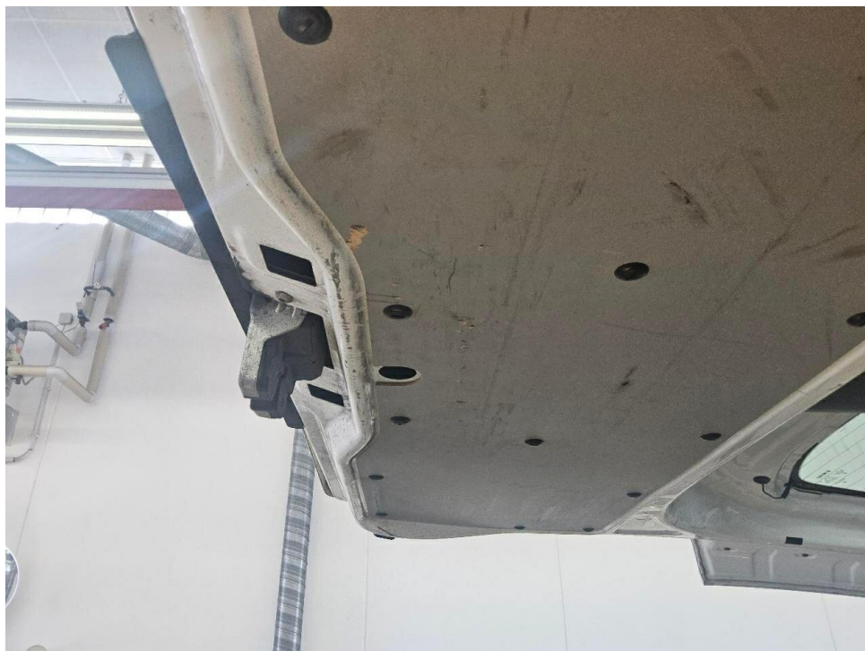
Bild 32 : Heckklappe Verkleidung, zerkratzt
