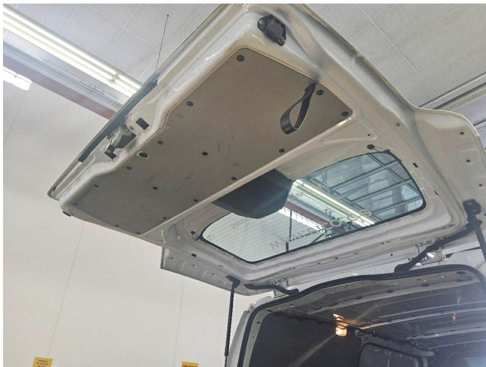
Bild 31 : Heckklappe Verkleidung, zerkratzt
