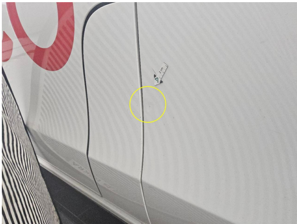
Bild 25 : Schiebetür links, eingedellt
