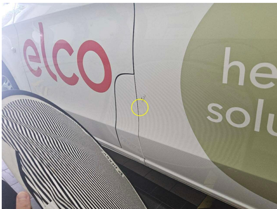
Bild 24 : Schiebetür links, eingedellt
