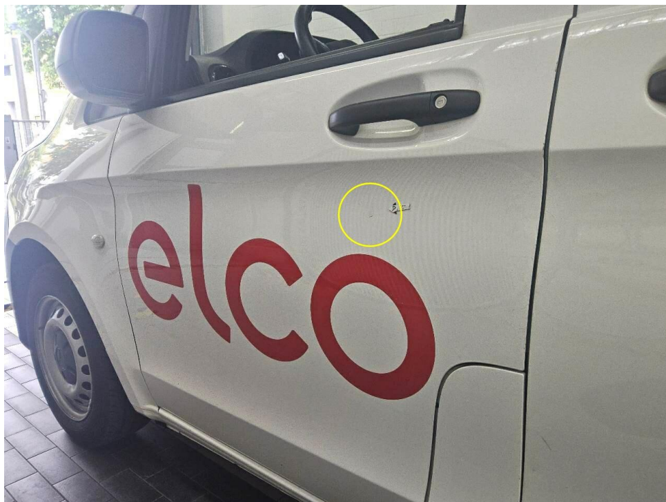
Bild 20 : Tür vorne links, eingedellt
