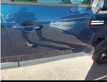
Puerta / Delantero Derecho / Abolladura
