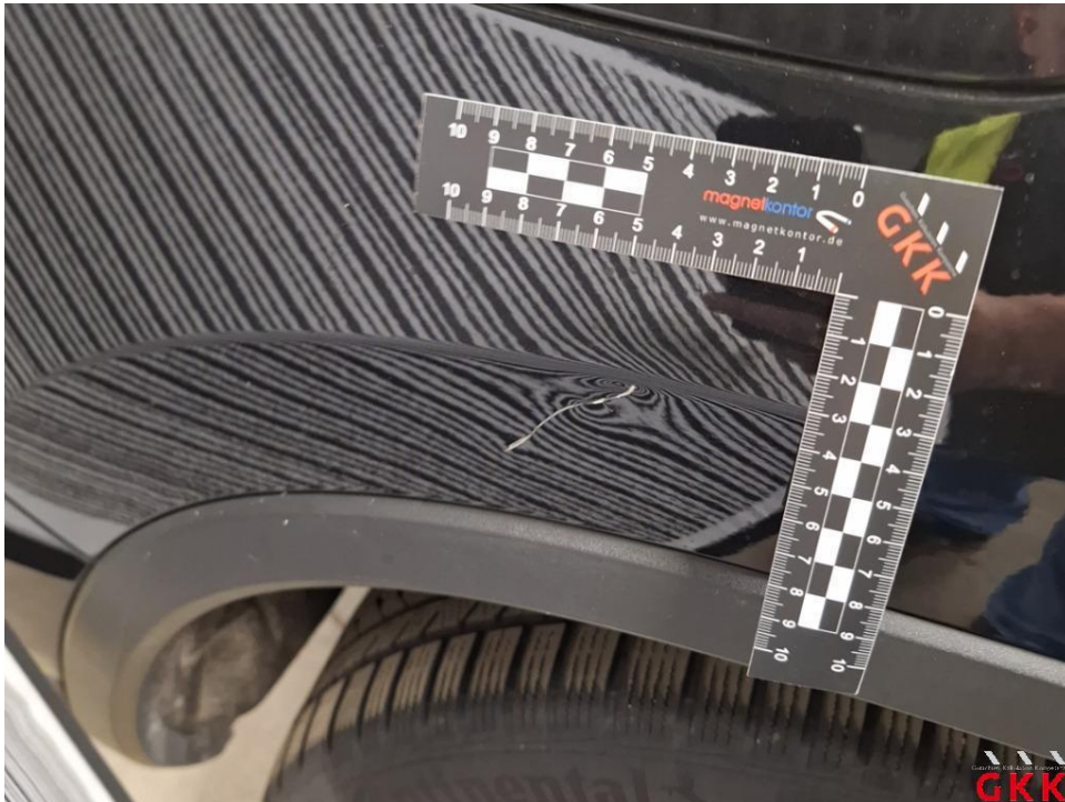
Bild 23 Seitenwand rechts, beschädigt, instand setzen - lackieren
