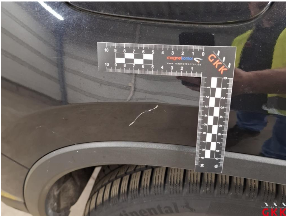
Bild 24 Seitenwand rechts, beschädigt, instand setzen - lackieren
