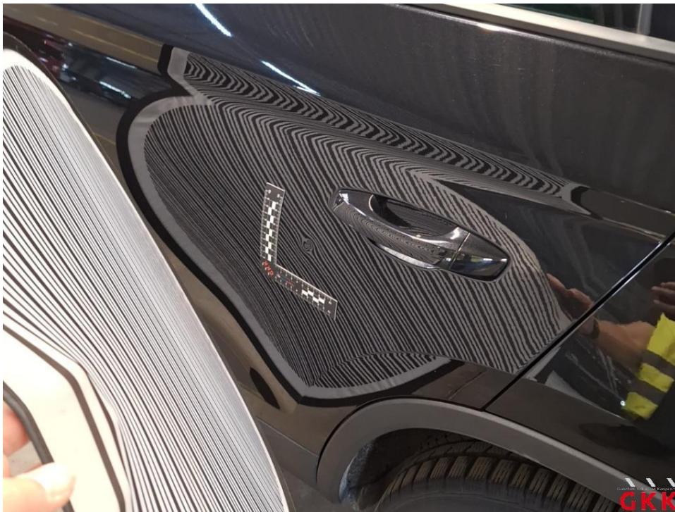
Bild 28 Tür hinten links, beschädigt, instand setzen - lackieren
