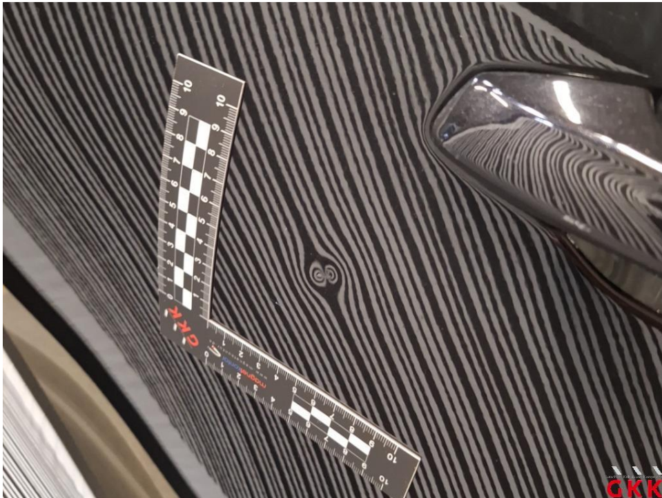
Bild 29 Tür hinten links, beschädigt, instand setzen - lackieren
