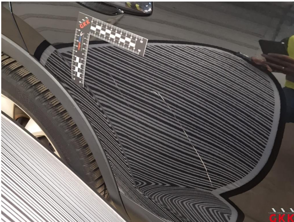
Bild 20 Tür hinten rechts, beschädigt, instand setzen - lackieren
