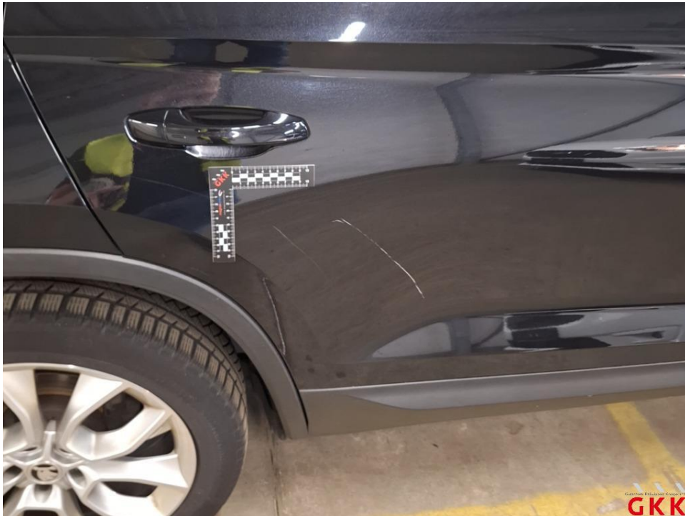
Bild 19 Tür hinten rechts, beschädigt, instand setzen - lackieren
