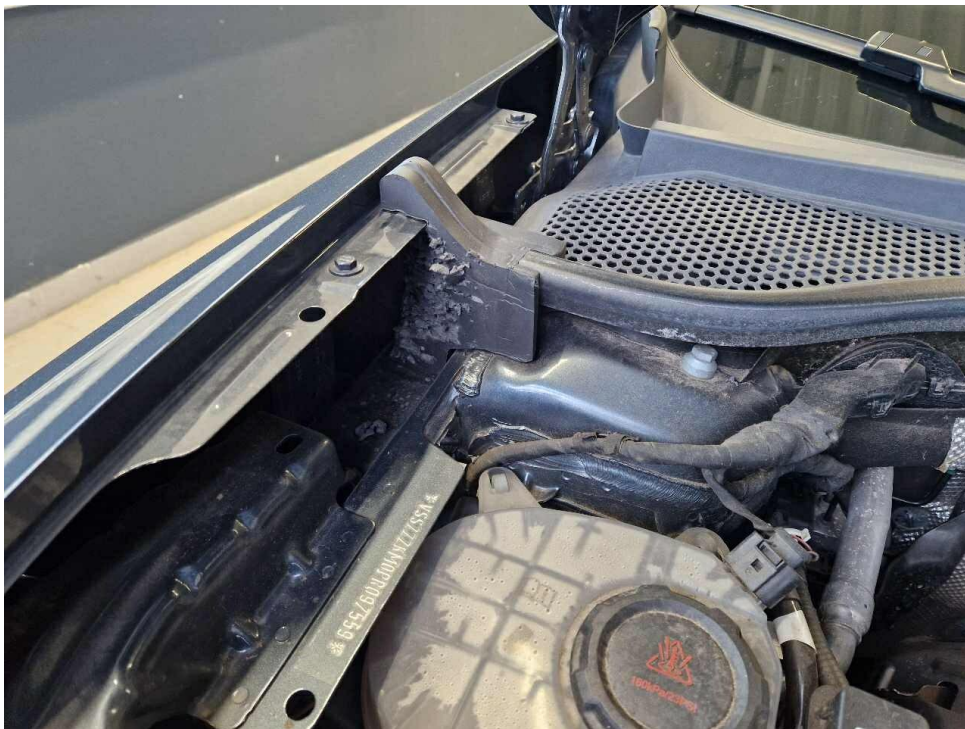
Bild 22 : Isolierung beschädigt Maderbiss
