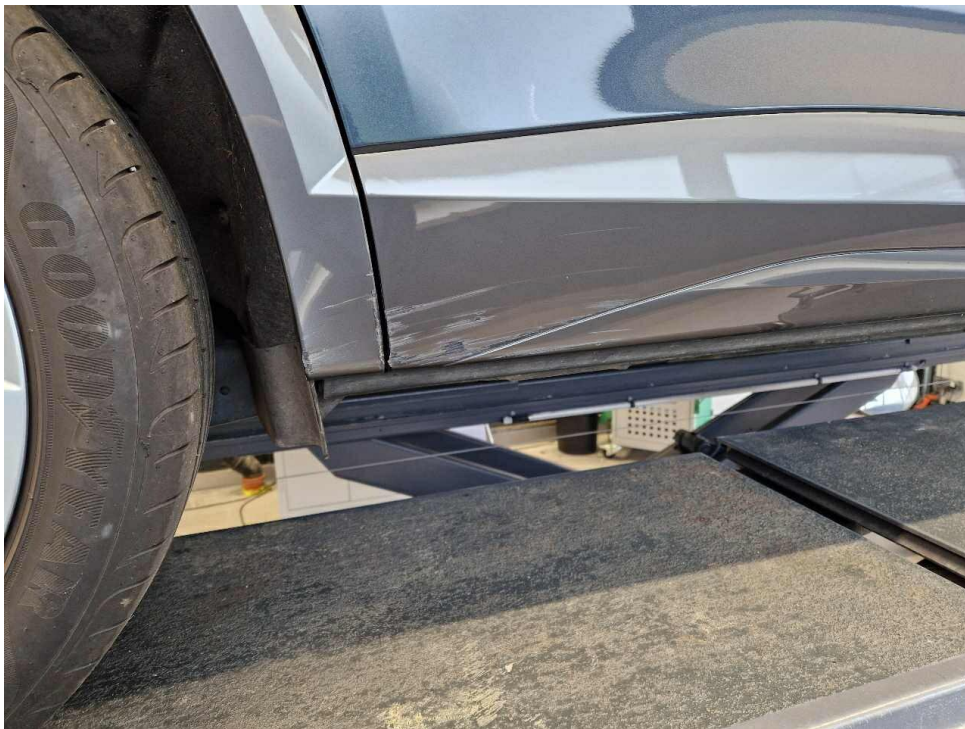
Bild 18 : Türblende hinten rechts verschürft
