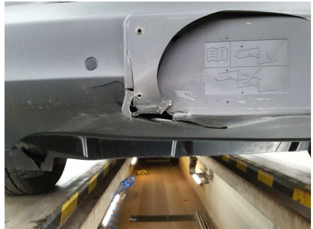
Beschädigung #11: Stossfänger vorn: Stossfänger mit Parktronic - gebrochen / gerissen - erneuern
