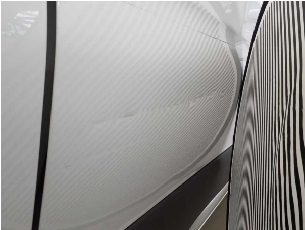
Beschädigung #12: Schiebetür rechts: Schiebetür - Delle / Lackschaden - instandsetzen/lackieren (S2)
