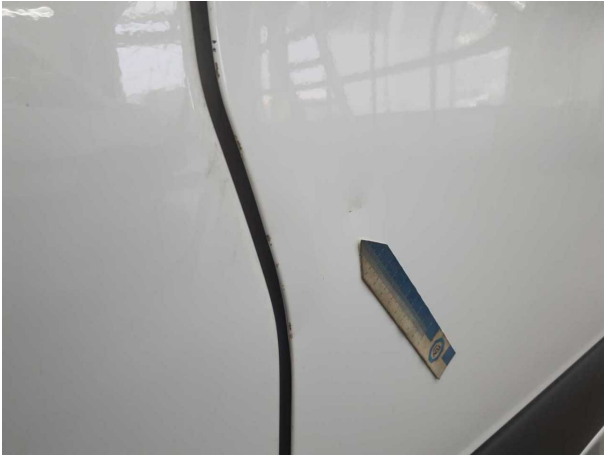
Beschädigung #6: Tür vorn rechts: Tür - Delle / Lackschaden - Smart Repair
