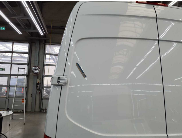
Beschädigung #2: Heckklappe/-tür: Hecktür links - Kratzer - Smart Repair
