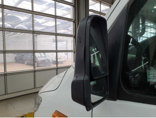
Beschädigung #1: Außenspiegel links: Abdeckkappe - verformt - erneuern
