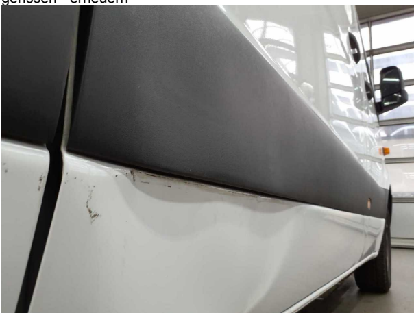
Beschädigung #5: Schiebetür rechts: Schutzleiste - verformt - erneuern
