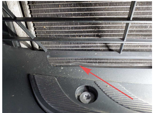
Beschädigung #10: Motorkühlung: Kühler - verformt - erneuern
