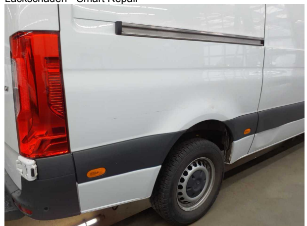
Beschädigung #8: Seitenwand rechts: Seitenwand (+ Bepunktung mitte) - Delle / Lackschaden - instandsetzen und lackieren
