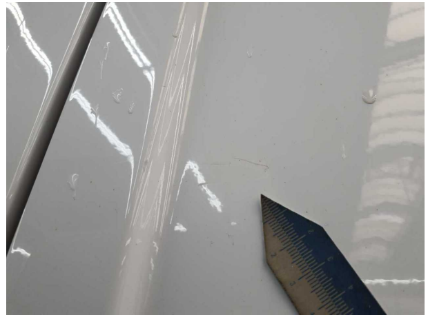
Beschädigung #2: Heckklappe/-tür: Hecktür links - Kratzer - Smart Repair
