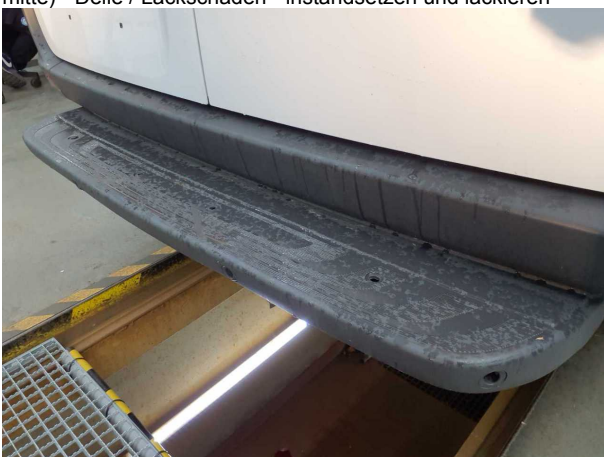
Beschädigung #9: Stossfänger hinten: Verkl. Stossfänger Auftritt mit Parktronic - verformt - erneuern
