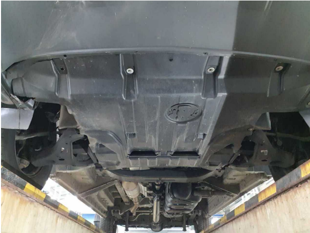
Beschädigung #4: Motor: Motorverkleidung unten - gebrochen / gerissen - erneuern
