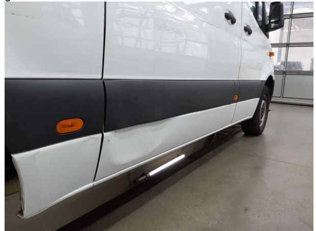
Beschädigung #5: Schiebetür rechts: Schutzleiste - verformt - erneuern
