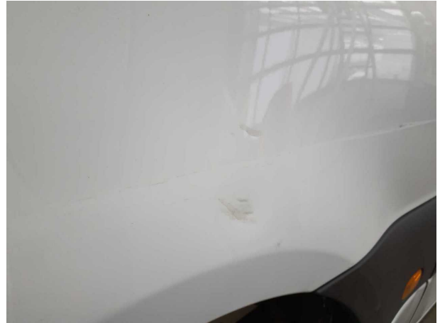
Beschädigung #8: Seitenwand rechts: Seitenwand (+ Beplankung mitte) - Delle / Lackschaden - instandsetzen und lackieren
