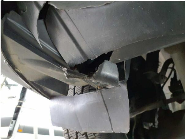
Beschädigung #4: Motor: Motorverkleidung unten - gebrochen / gerissen - erneuern
