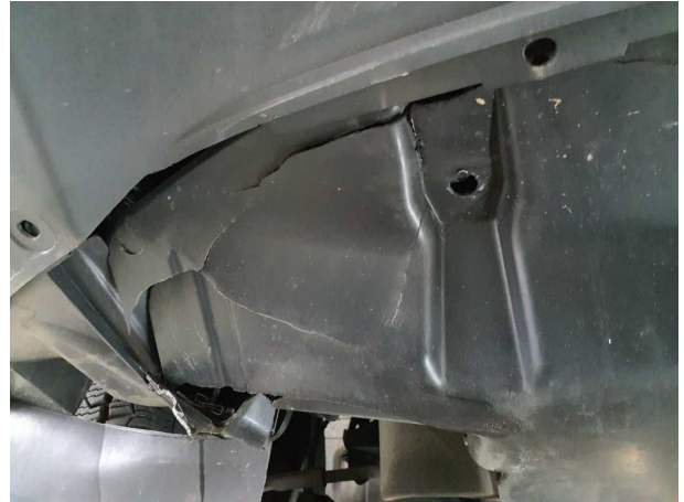
Beschädigung #4: Motor: Motorverkleidung unten - gebrochen / gerissen - erneuern
