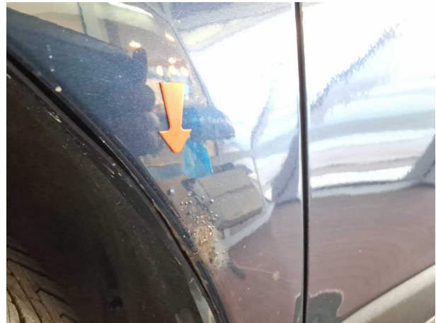
Beschädigung #4: Kotflügel links: Kotflügel links - Korrosion - instandsetzen und lackieren
