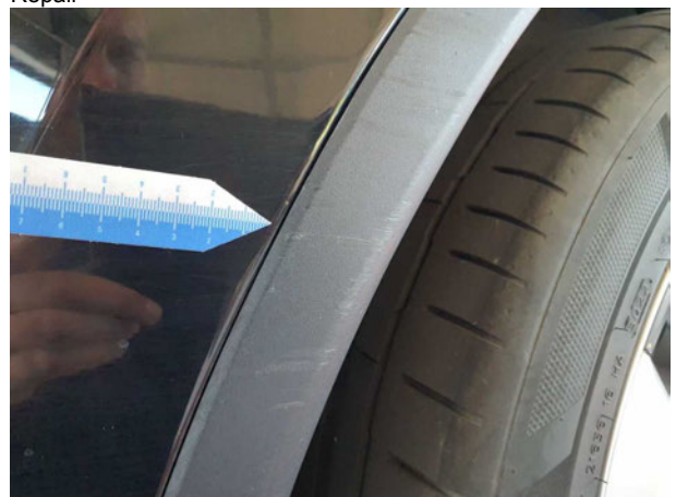
Beschädigung #2: Seitenwand rechts: Radlauf - verkratzt / verschürft - erneuern
