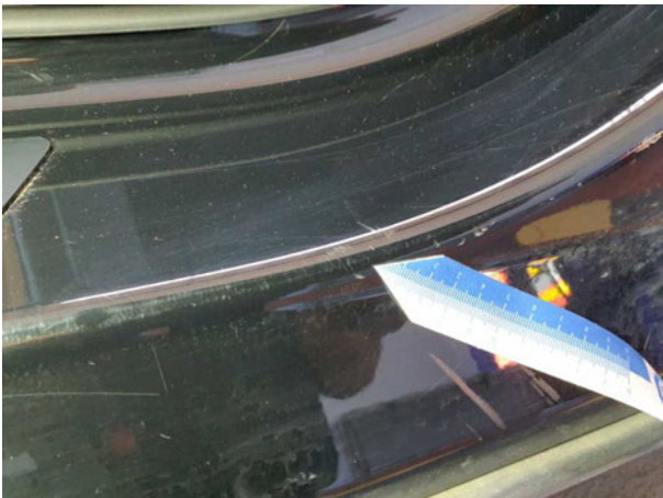
Beschädigung #1: Schweller links: Einstieg - Kratzer - Smart Repair
