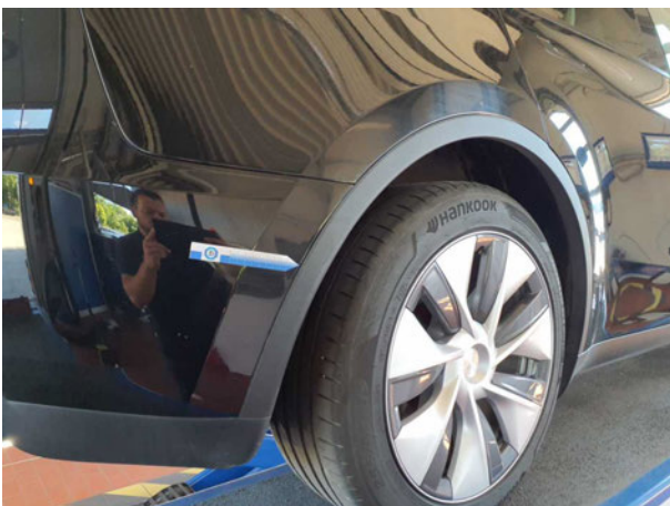
Beschädigung #2: Seitenwand rechts: Radlauf - verkratzt / verschürft... erneuern
