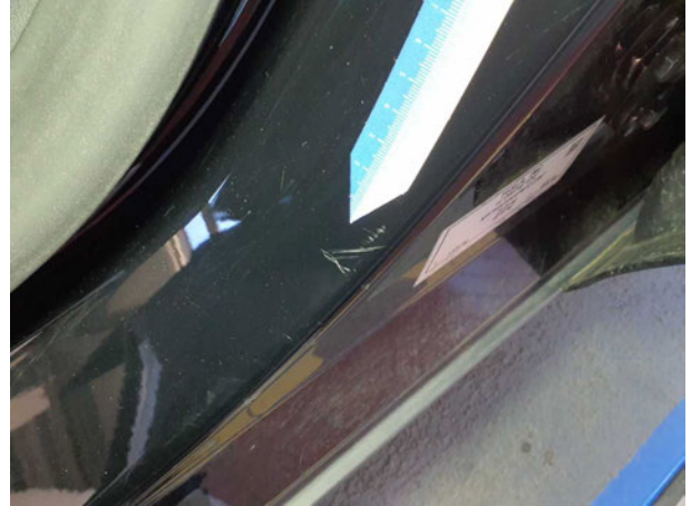
Beschädigung #1: Schweller links: Einstieg - Kratzer - Smart Repair
