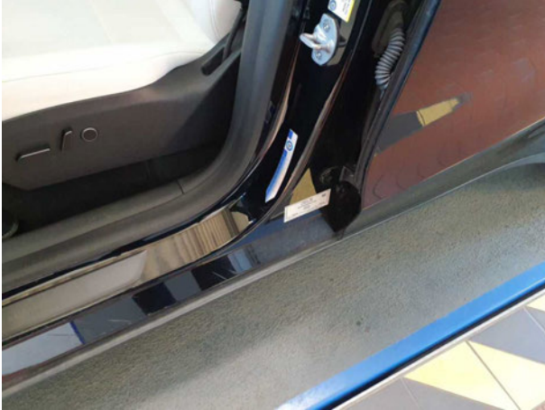
Beschädigung #1: Schweller links: Einstieg - Kratzer - Smart Repair
