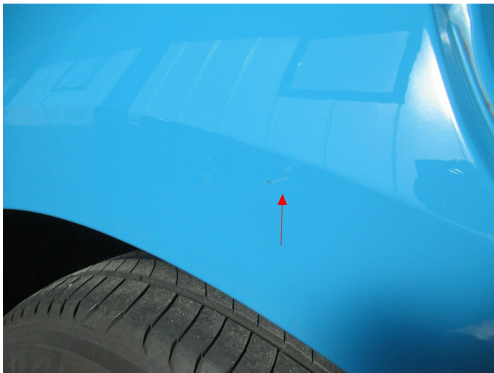
Bild 11 : Radlaufverkleidung hinten rechts mehrfach verkratzt
