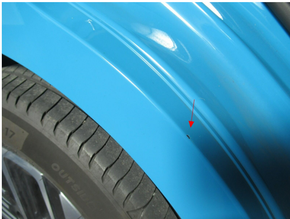
Bild 10 : Radlaufverkleidung hinten rechts mehrfach verkratzt
