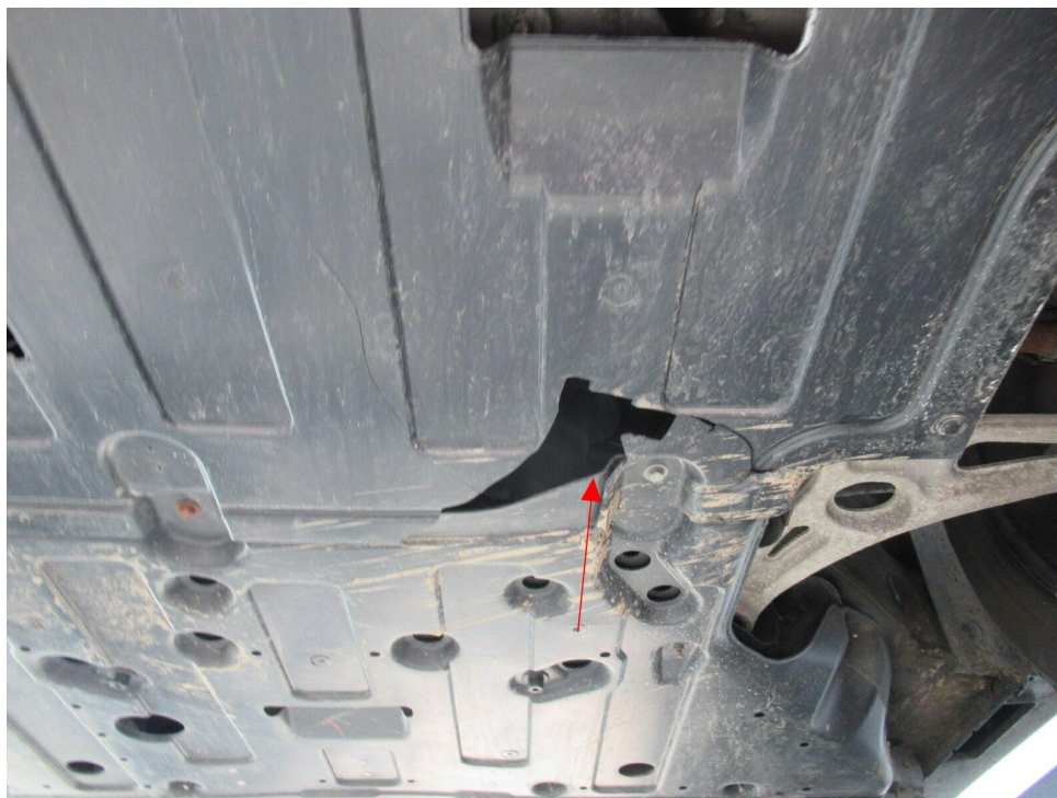
Bild 9 : Verkleidung Unterboden gebrochen
