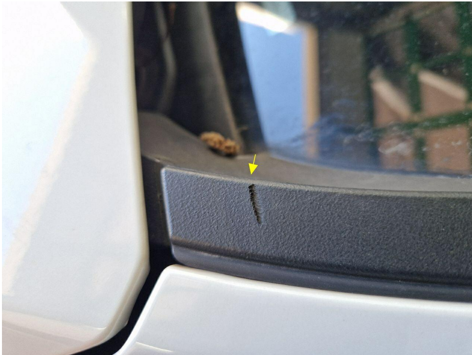
Bild 30 : Fensterleiste links Kratzer
