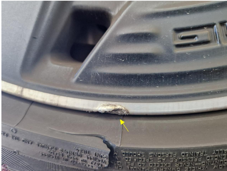
Bild 20 : Alufelge Glanzgedreht vorn links verschrammt
