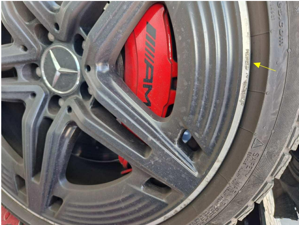
Bild 26 : Alufelge Glanzgedreht vorn rechts verschrammt
