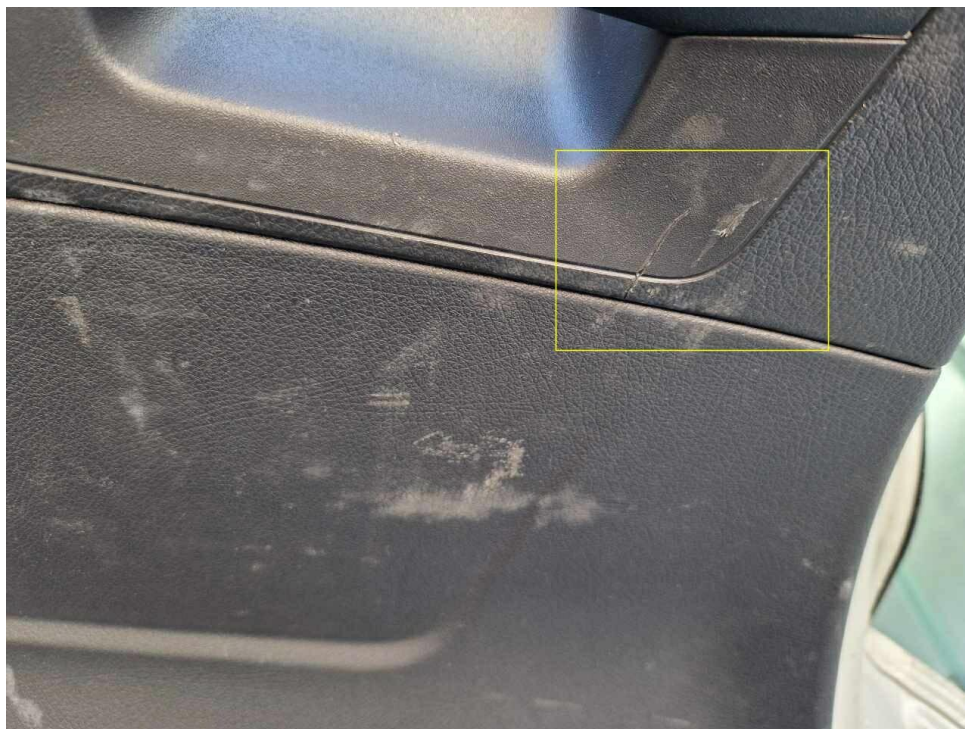
Bild 16 : Verkleidung Heckklappe zerkratzt
