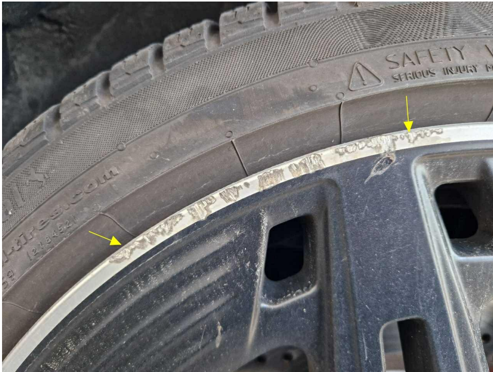
Bild 22 : Alufelge Glanzgedreht hinten links verschrammt
