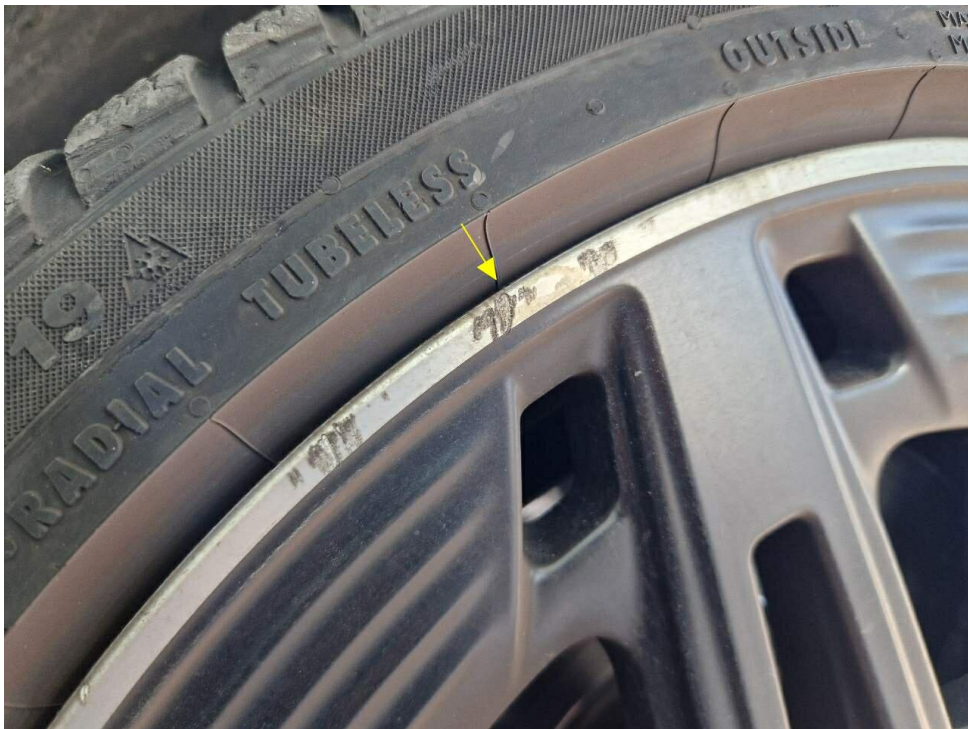
Bild 27 : Alufelge Glanzgedreht vorn rechts verschrammt
