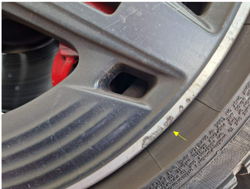
Bild 28 : Alufelge Glanzgedreht vorn rechts verschrammt
