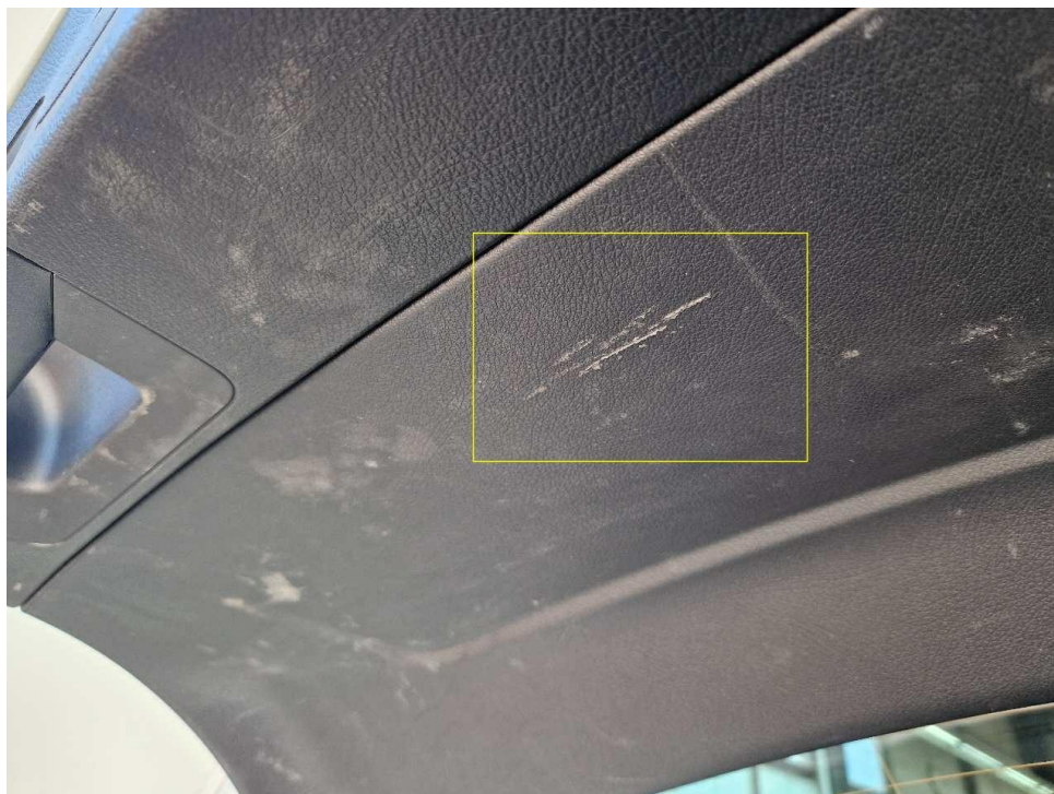
Bild 15 : Verkleidung Heckklappe zerkratzt
