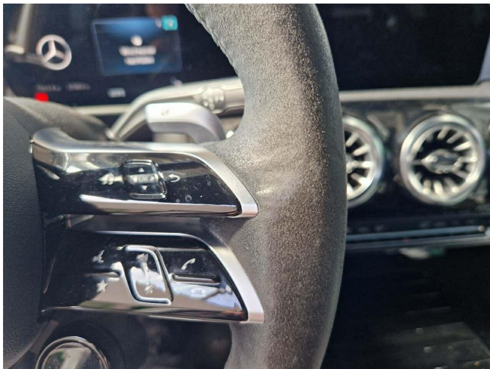
Bild 19 : Alcantara Lenkrad abgenutzt
