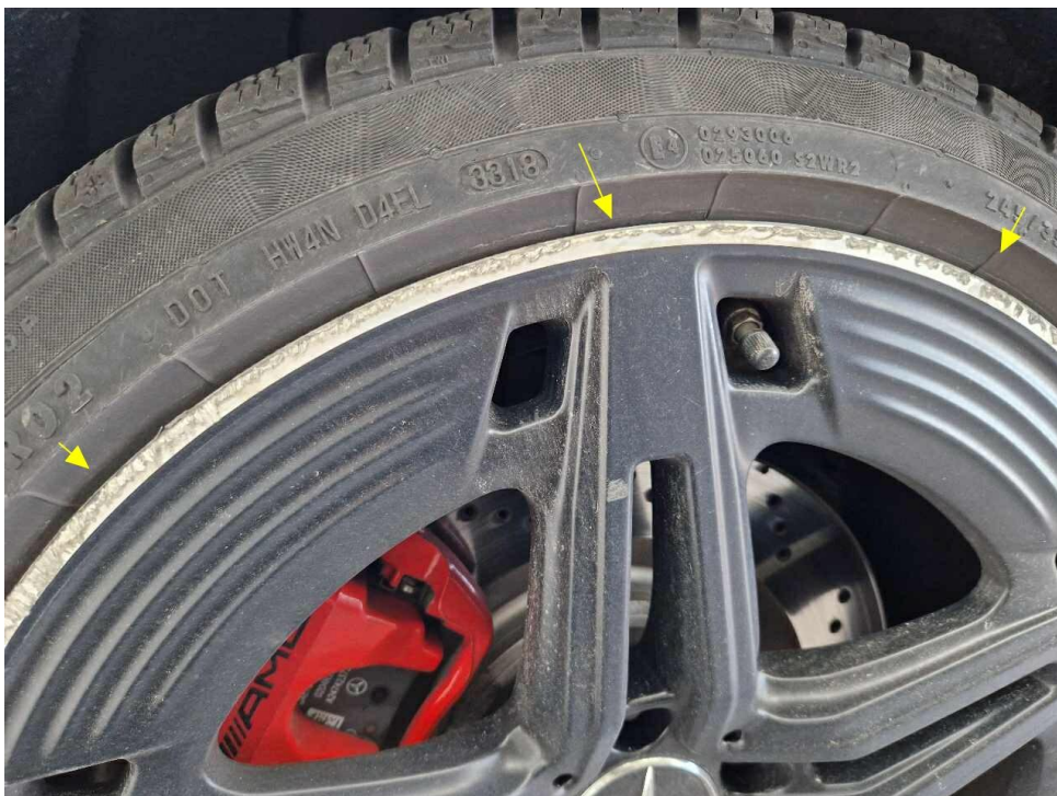
Bild 25 : Alufelge Glanzgedreht hinten rechts verschrammt
