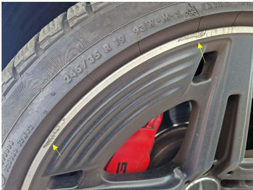
Bild 21 : Alufelge Glanzgedreht vorn links verschrammt
