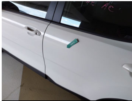
Tür / Hinten Links / Delle
