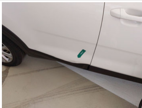
Tür / Hinten Rechts / Delle
