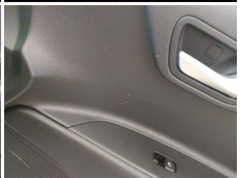
Türverkleidung / Vorne Rechts / Kratzer
