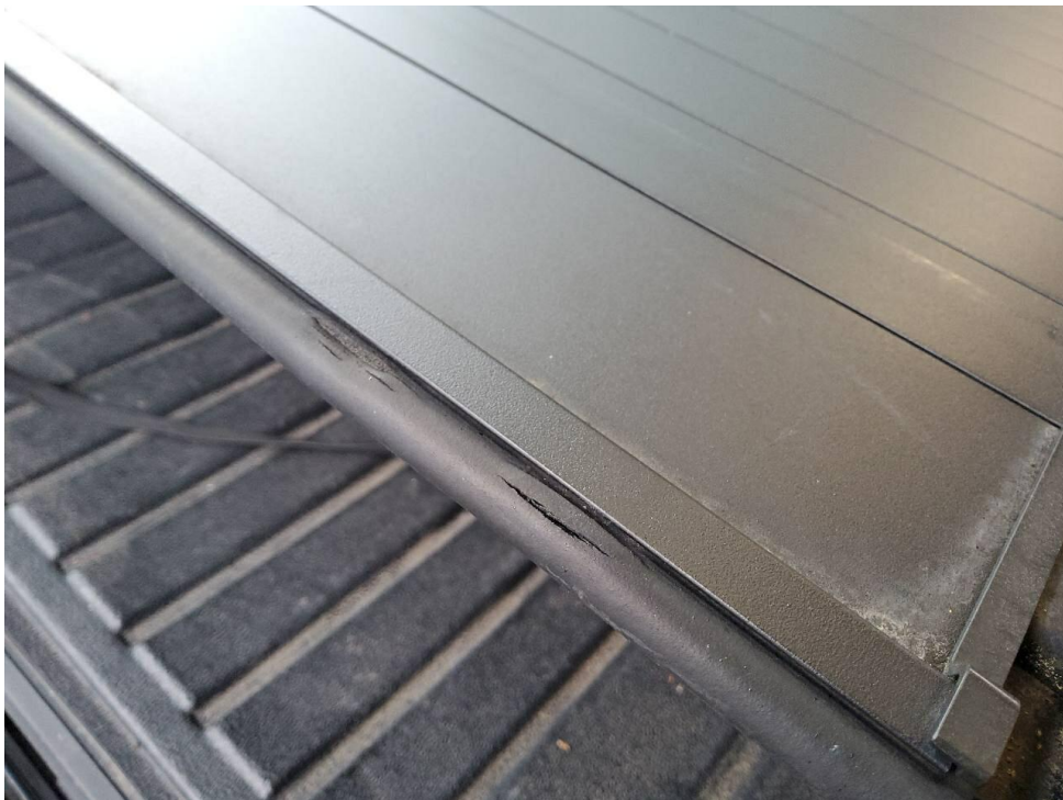
Bild 16 : Laderaumrollo Gummidichtung Beschädigt
