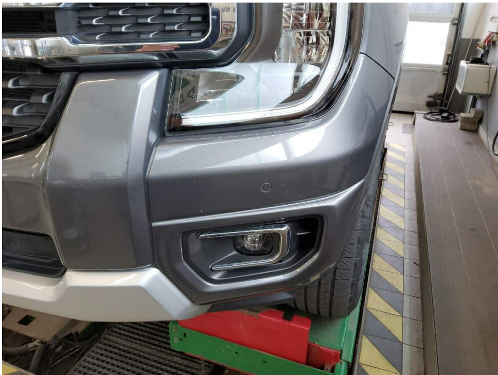
Bild 14 : Stoßfänger vorne Steinschlag
