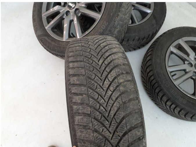
Damage 5: 2nd wheel set: 2 tyres (Einseitig abgefahren) - Worn - Replace
