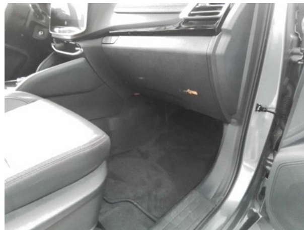
Beschädigung #2: Instrumententafel: Handschuhfachdeckel - verkratzt / verschürft - Smart Repair
