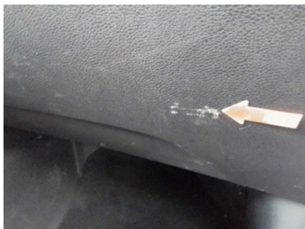
Beschädigung #2: Instrumententafel: Handschuhfachdeckel - verkratzt / verschürft - Smart Repair
