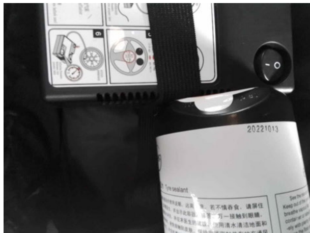
Beschädigung #1: Ausrüstung: Tirefit Füllmittel - abgelaufen - erneuern
