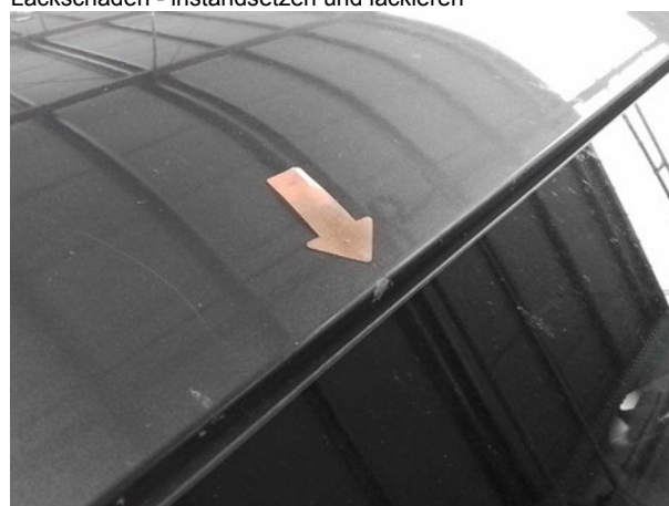
Beschädigung #6: Fahrzeugdach: Dach - Steinschlag - lackieren
