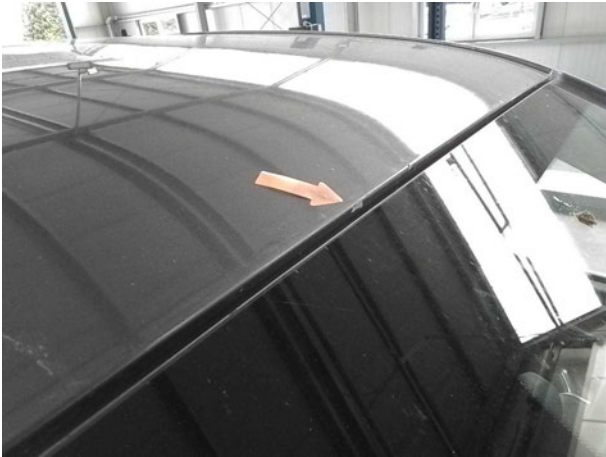
Beschädigung #6: Fahrzeugdach: Dach - Steinschlag - lackieren
