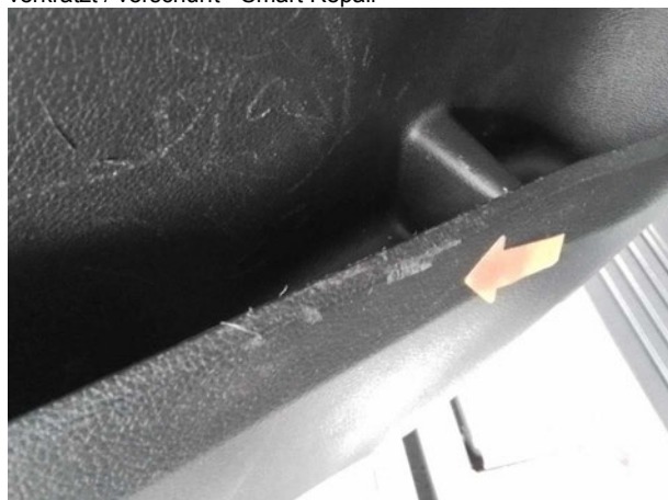
Beschädigung #3: Verkleidungen/Abdeckungen: Türverkleidung hinten links - verkratzt / verschürft - Smart Repair
