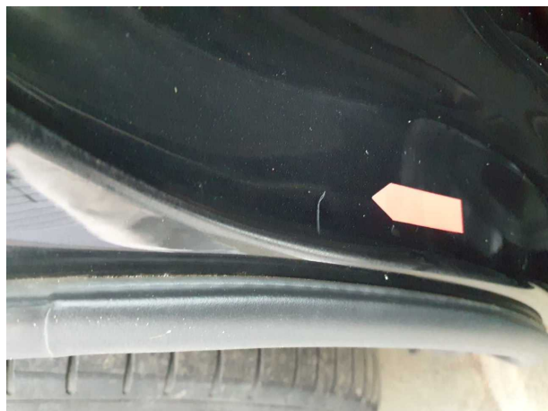
Beschädigung #3: Seitenwand rechts: Einstieg - Kratzer - Smart Repair
