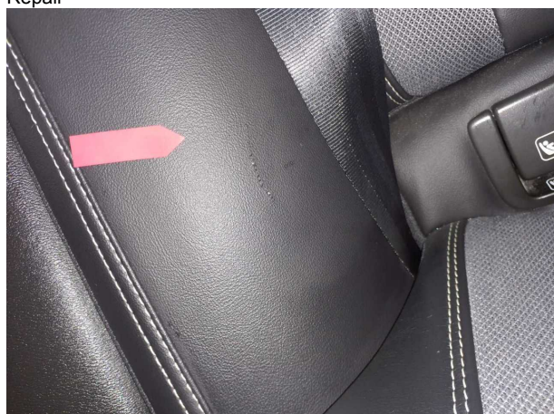
Beschädigung #4: Sitz hinten: Rücksitz - Kratzer - Smart Repair
