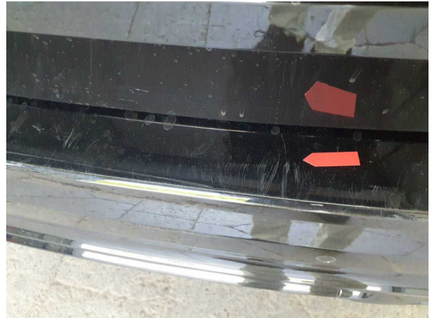
Beschädigung #10: Stossfänger hinten: Stossfänger hinten - Kratzer - lackieren
