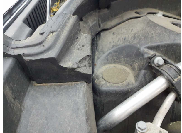
Beschädigung #1: Motor: Motorabdeckung (Füllstoff) - beschädigt - erneuern
