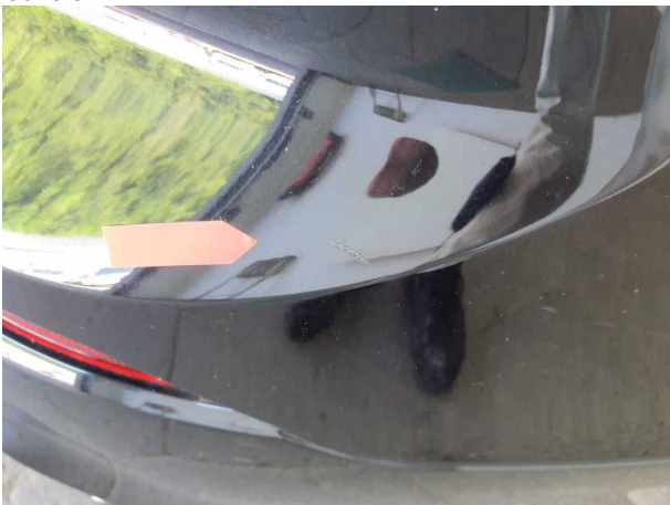
Beschädigung #10: Stossfänger hinten: Stossfänger hinten - Kratzer - lackieren
