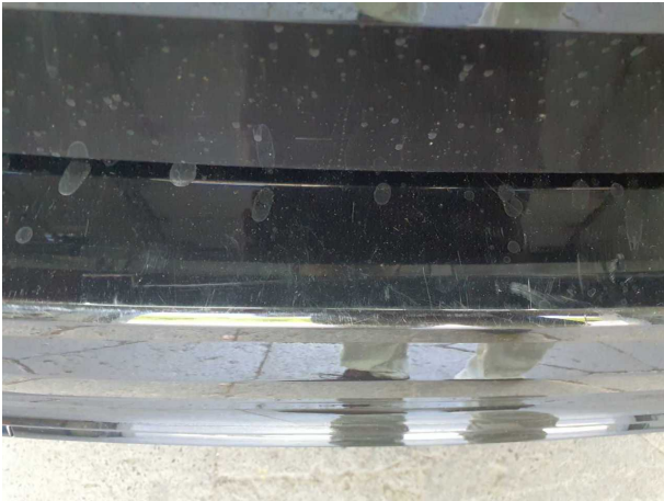
Beschädigung #10: Stossfänger hinten: Stossfänger hinten - Kratzer - lackieren
