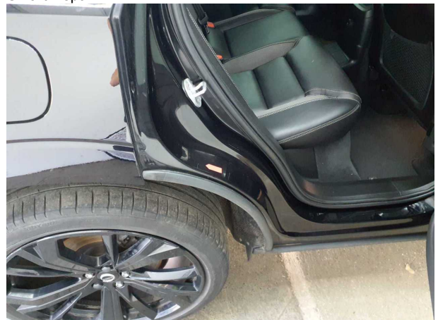
Beschädigung #3: Seitenwand rechts: Einstieg - Kratzer - Smart Repair
