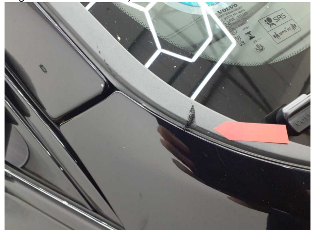
Beschädigung #8: Verglasung: Frontscheibe (Zierleiste Regenrinne links & rechts) - Kratzer - erneuern
