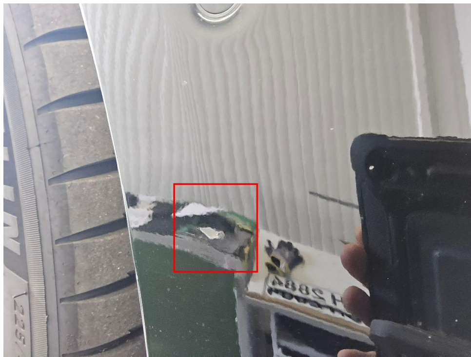
Bild 22 : Stoßfänger vorne, zerkratzt
