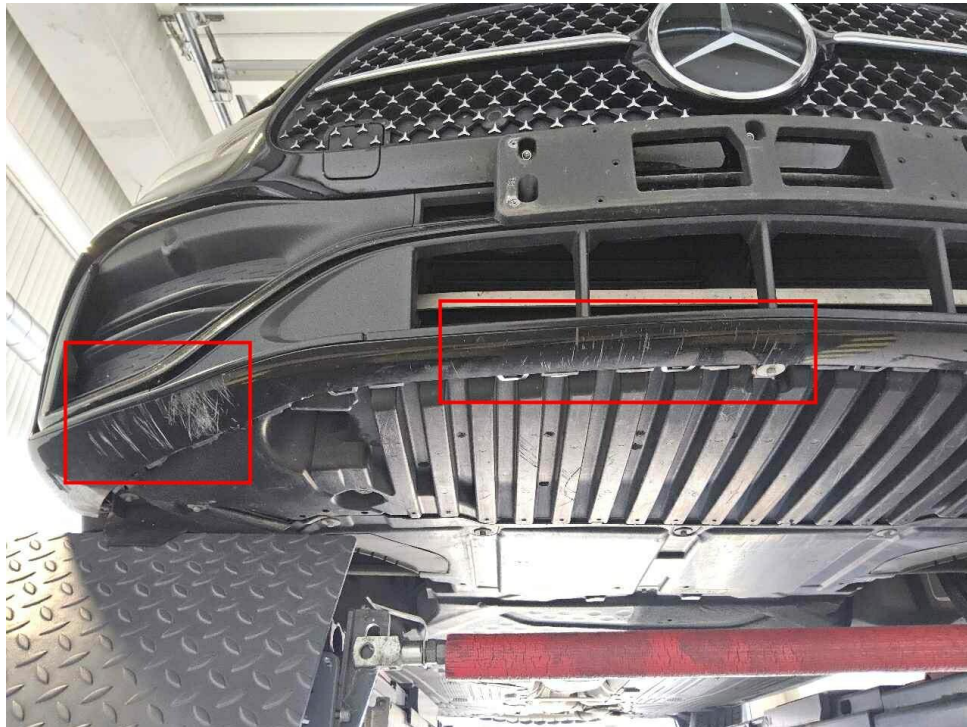
Bild 23 : Stoßfänger vorne, zerkratzt
