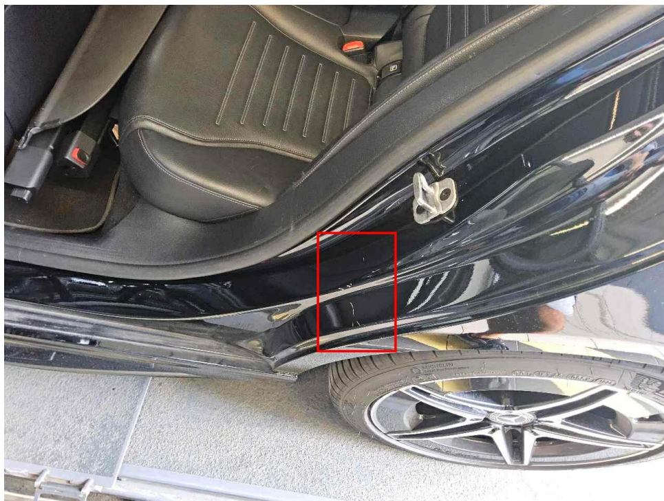
Bild 15 : Einstieg hinten links, zerkratzt
