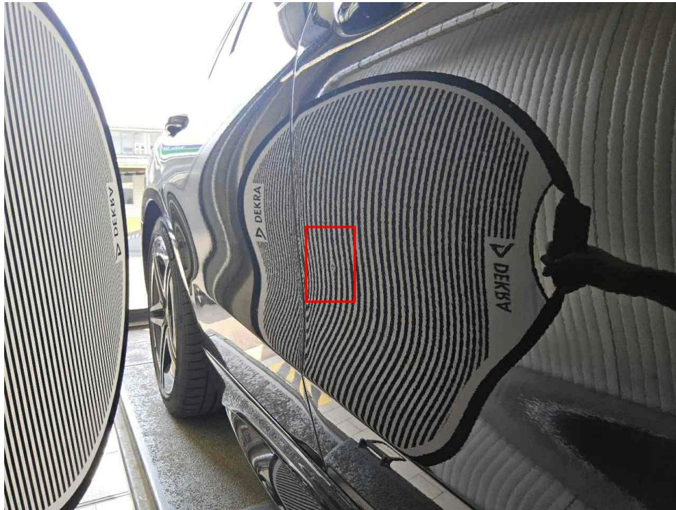
Bild 19 : Türe vorne rechts, eingedellt mit Lackschaden
