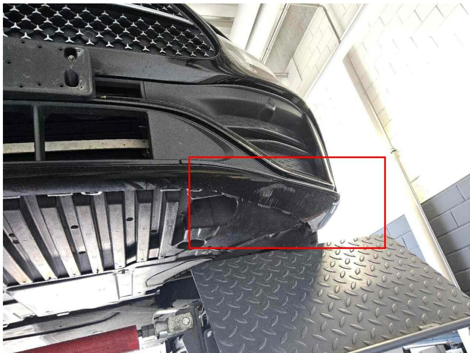
Bild 24 : Stoßfänger vorne, zerkratzt
