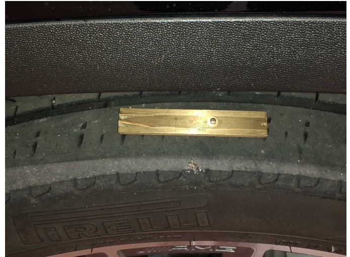
Damage 5: Wheel / tyres: Tyre - front (Einseitig abgefahren) - Worn - Replace
