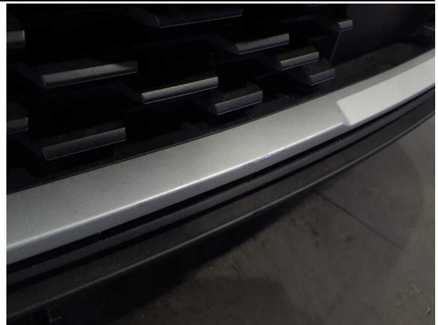
Beschädigung #3: Stossfänger vorn: Spoiler - nicht fachgerecht instandgesetzt - erneuern
