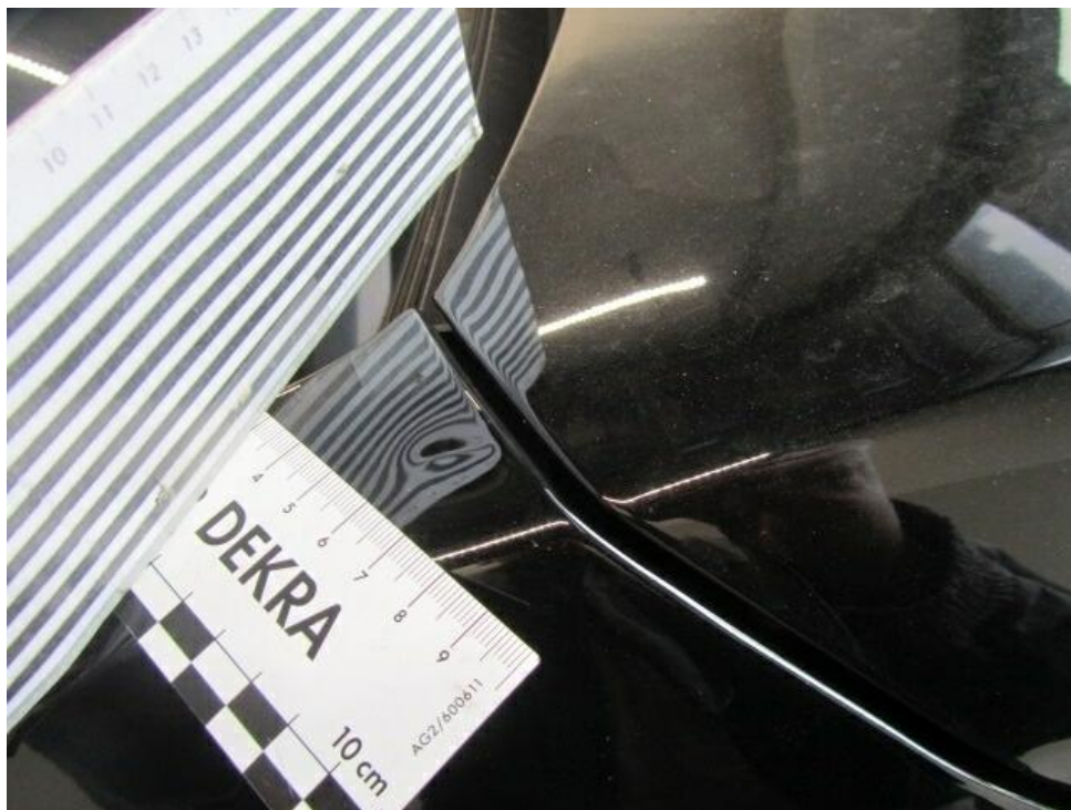
Bild 20 : Kotflügel vorne rechts, eingedellt, drücken
