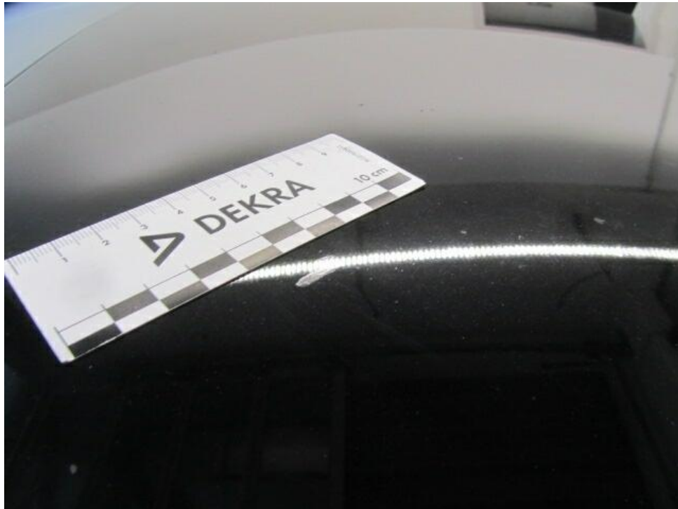
Bild 19 : Dach Lackierung, fleckig, reinigen
