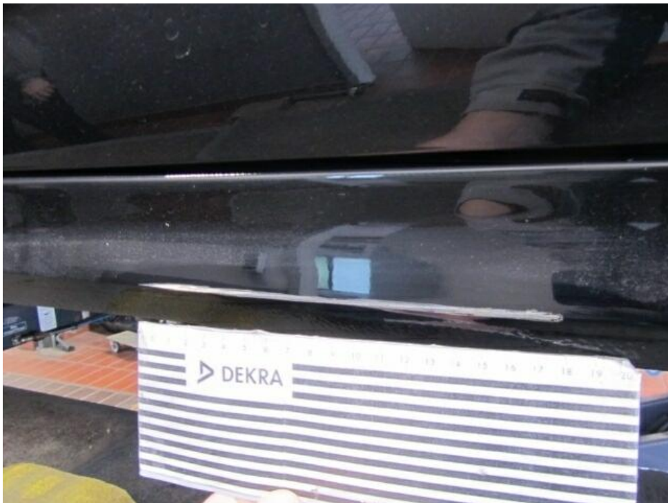
Bild 16 : Seitenschweller rechts Lackierung, verschrammt, smart repair
