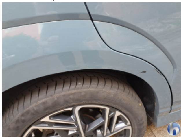
2. Schweller - Rechts Kratzer - Lackieren
