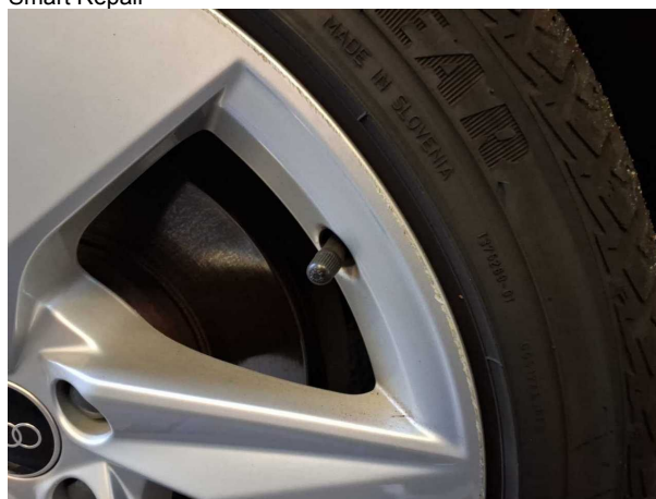
Beschädigung #3: Rad/Reifen: Leichtmetallfelge vorn links - verkratzt / verschürft - Smart Repair
