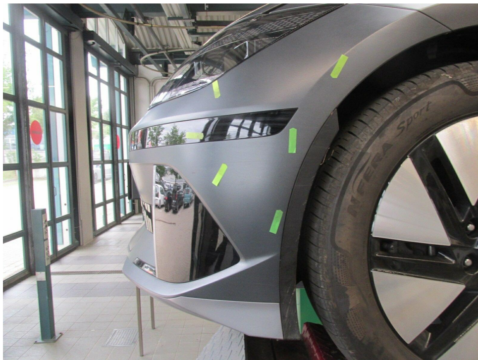
Bild 10 : leichte Streifschäden am vorderen Stoßfänger links
