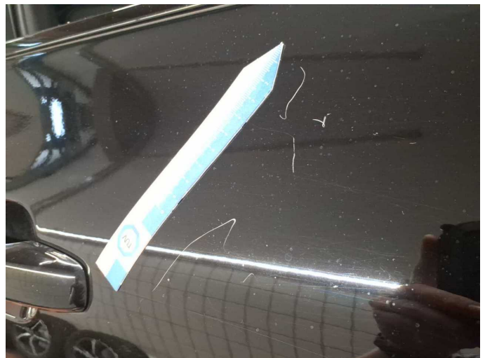
Damage 12: Door - front right side: Door - Scratch(es) - Paint
