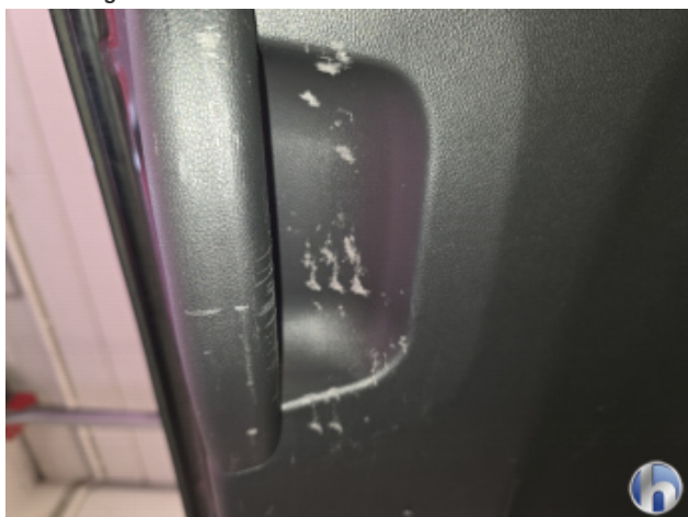
4. Kofferraumverkleidung Links Beschädigt - Erneuern
