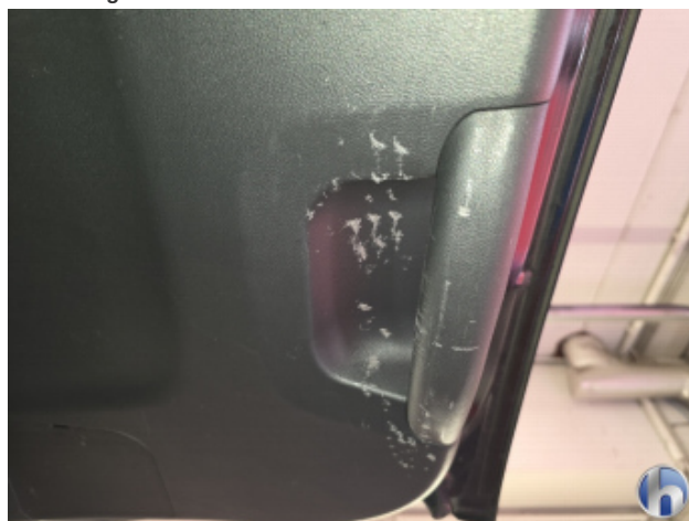
4. Kofferraumverkleidung Links Beschädigt - Erneuern
