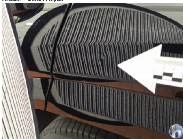
2. Seitenwand - Hinten - Links 1 Delle - Sanft Instandsetzen
