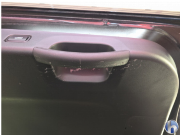
4. Kofferraumverkleidung Links Beschädigt - Erneuern
