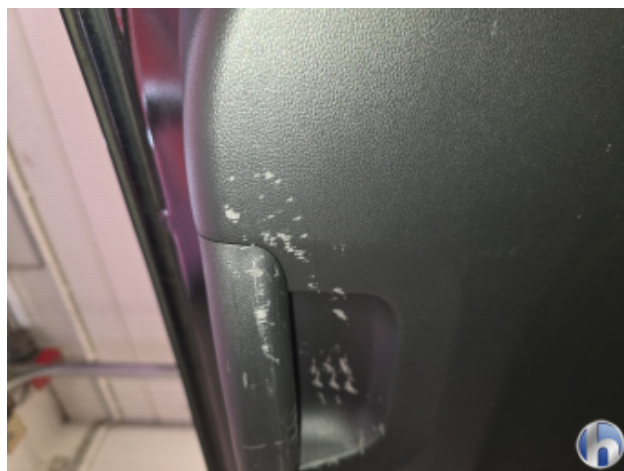
4. Kofferraumverkleidung Links Beschädigt - Erneuern
