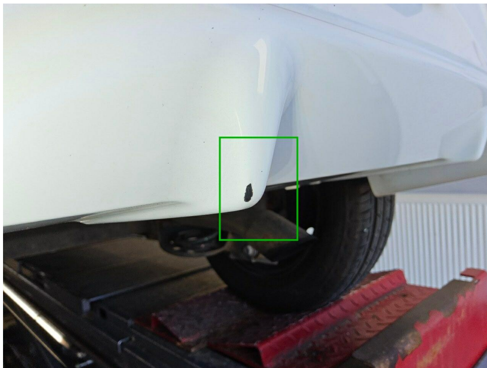
Bild 19 : Stoßfänger hinten, verschrammt
