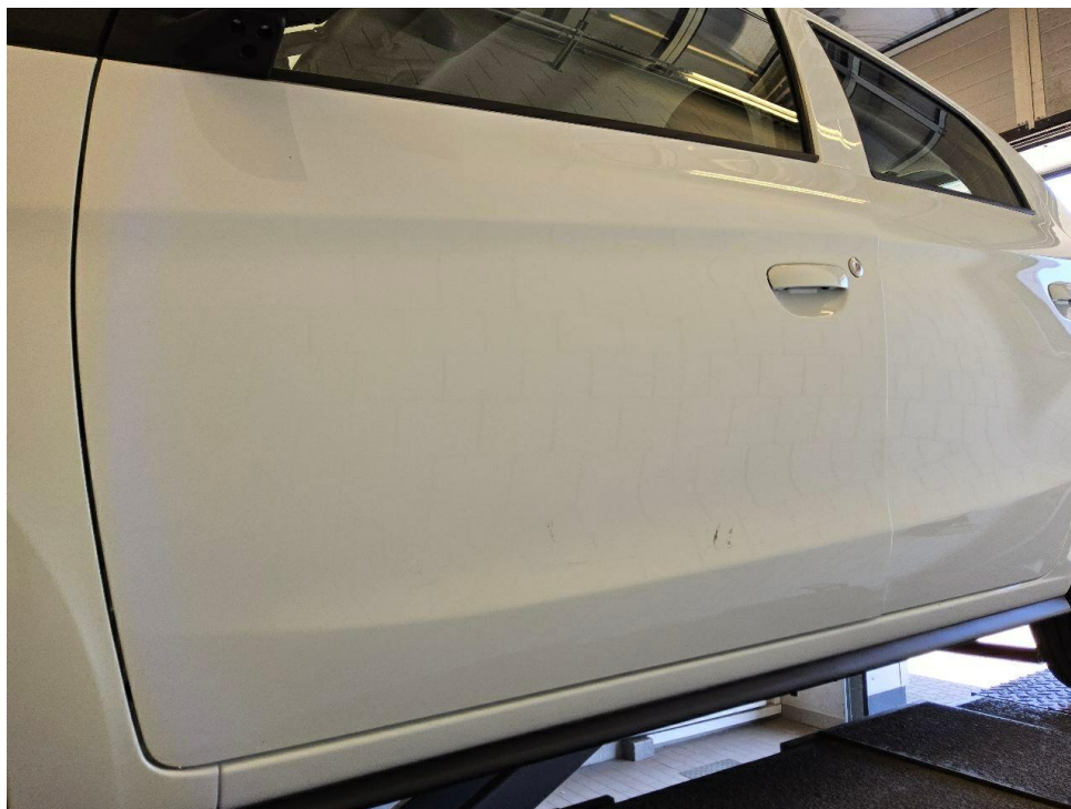
Bild 15 : Tür vorne links, Klebereste
