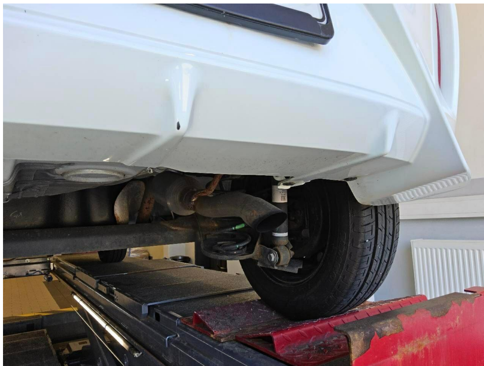
Bild 18 : Stoßfänger hinten, verschrammt
