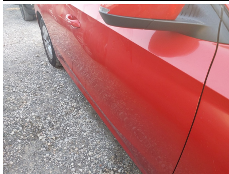
Puerta / Delantero Derecho / Abolladura
