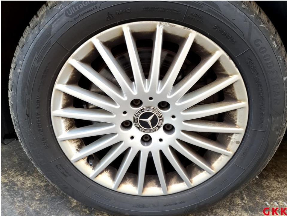
Bild 25 LM-Rad, vorne links, verkratzt, lackieren
