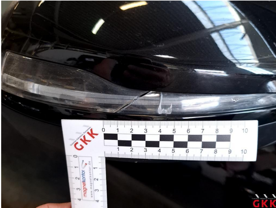
Bild 27 Spiegelgehäuse rechts, Blinker, zerbrochen, ersetzen
