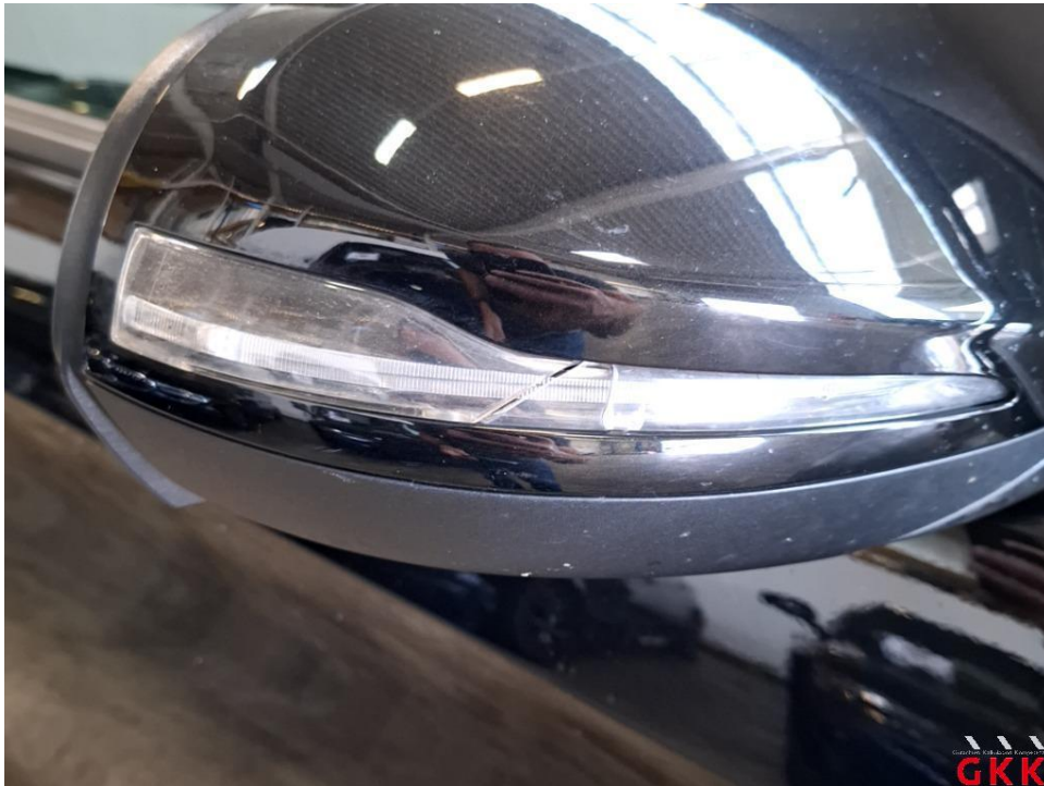
Bild 26 Spiegelgehäuse rechts, Blinker, zerbrochen, ersetzen
