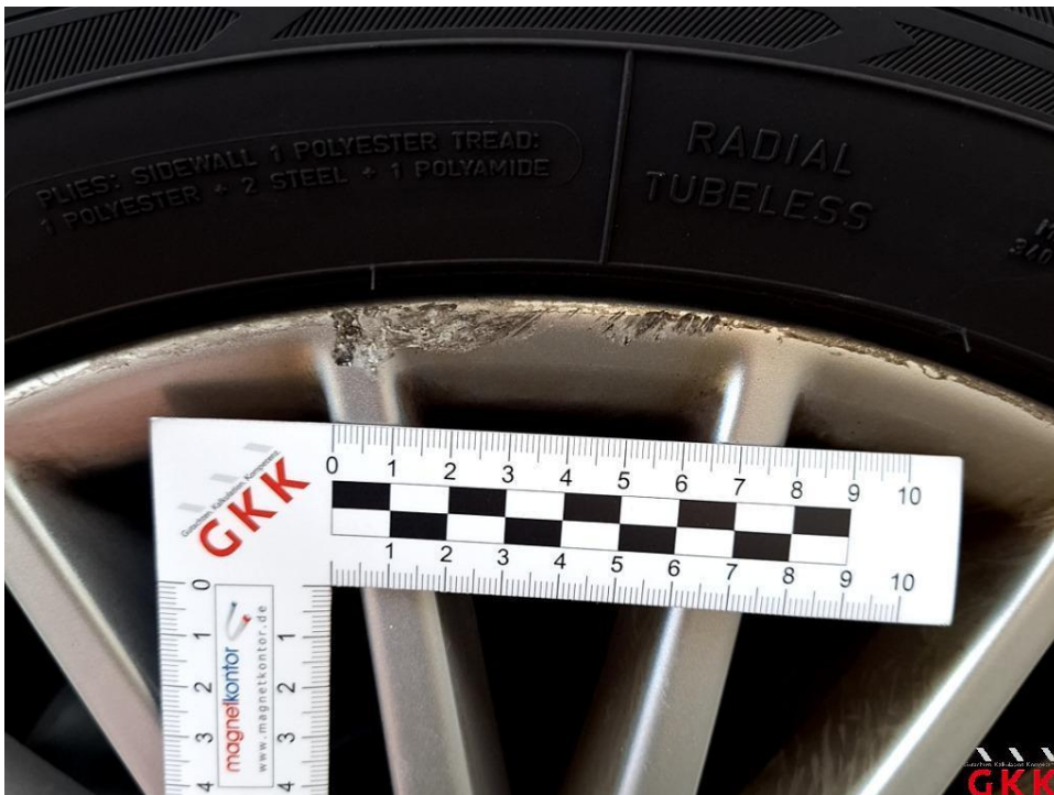
Bild 24 LM-Rad, vorne links, verkratzt, lackieren
