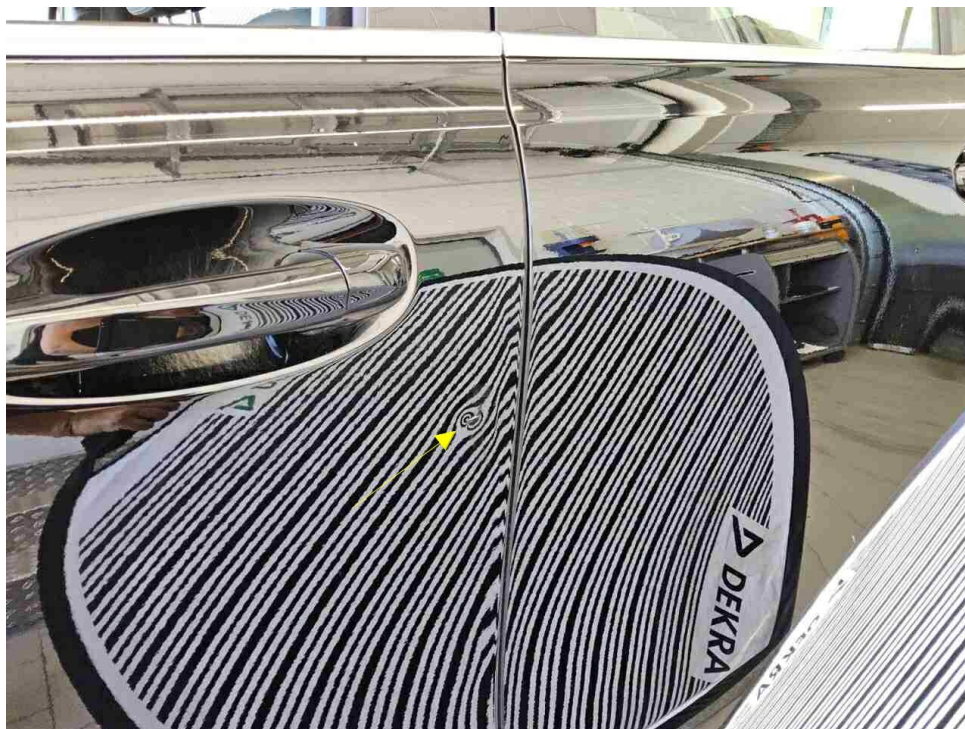
Bild 16 : Tür vorne links, eingedellt, instandsetzen und lackieren mit Lackaufbau
