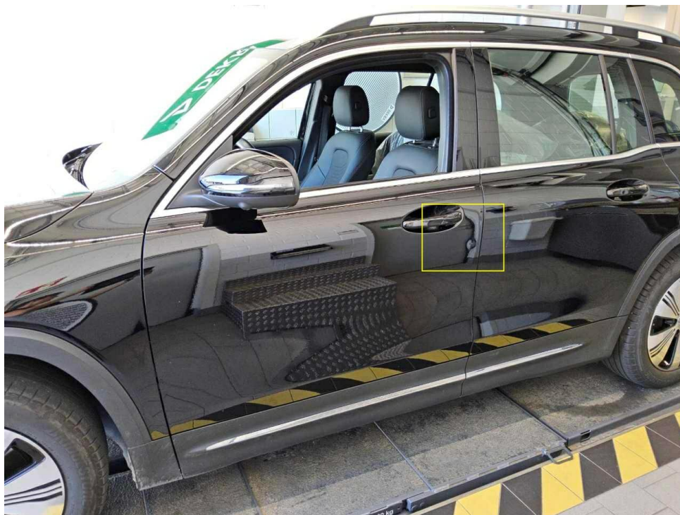
Bild 15 : Tür vorne links, eingedellt, instandsetzen und lackieren mit Lackaufbau
