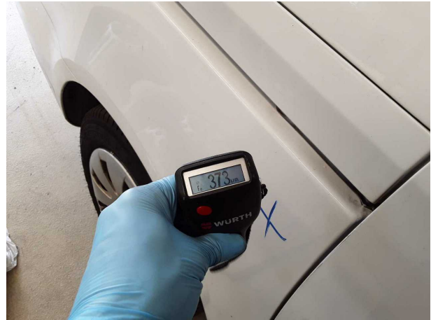
Nachlackierung 1: Seitenwand rechts, Tür hinten rechts
