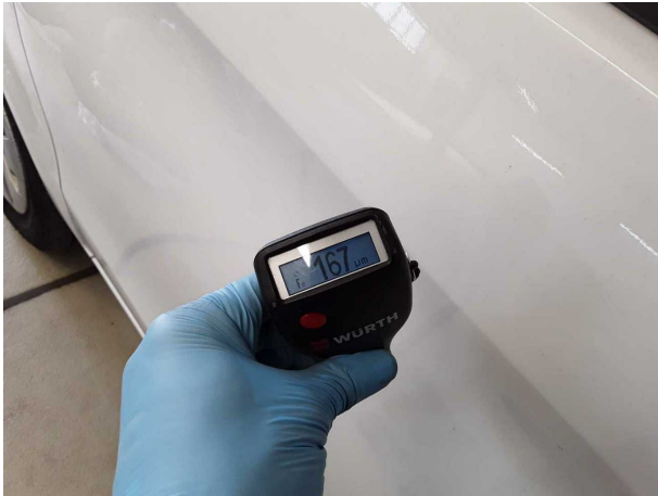
Nachlackierung 1: Seitenwand rechts, Tür hinten rechts
