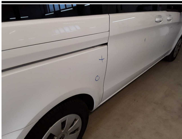
Beschädigung #7: Seitenwand rechts: Seitenwand - Delle(n) - sanft instandsetzen
