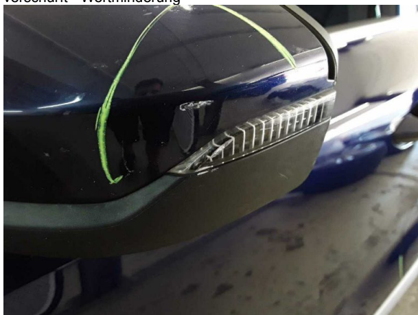
Beschädigung #7: Blinkleuchte: Spiegel links - verkratzt / verschürft - erneuern
