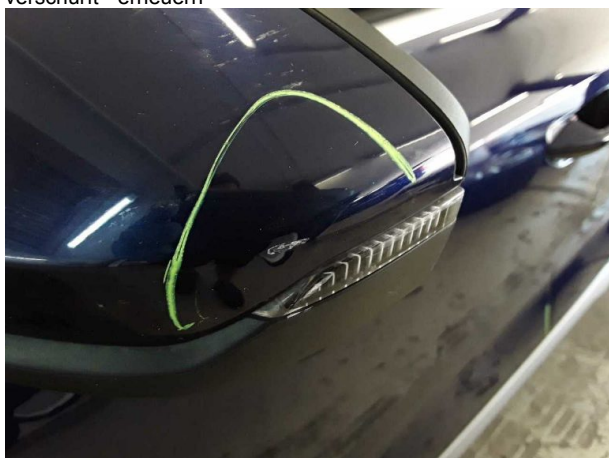
Beschädigung #8: Außenspiegel links: Abdeckkappe - verkratzt / verschürft - Smart Repair
