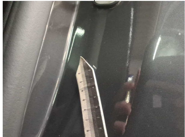
Beschädigung #2: Seitenwand links: Kniestück - verkratzt / verschürft - Smart Repair
