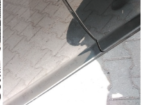
Tür / Vorne Links / Delle
