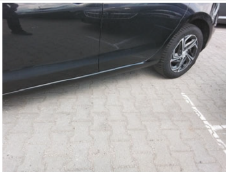
Schweller / Links / Kratzer
