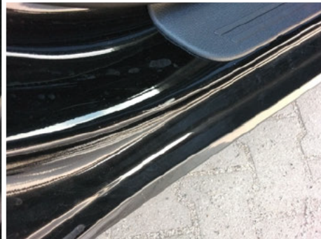
Türeinstieg / Hinten Rechts / Kratzer
