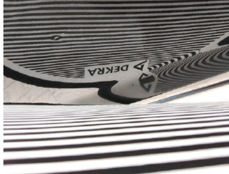
Tür / Vorne Links / Delle
