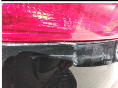
Heckleuchten Stoßfänger / Hinten Links / Kratzer
