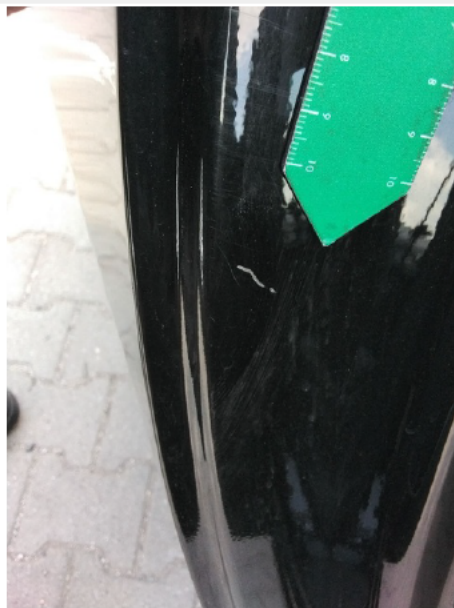
Türeinstieg / Hinten Rechts / Kratzer
