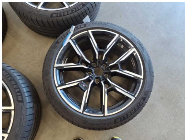
Damage #2: 2nd wheel set: 1 alloy rim (Abbrichtsicherheitsrelevante Beschädigung) - Scratch(es) -
