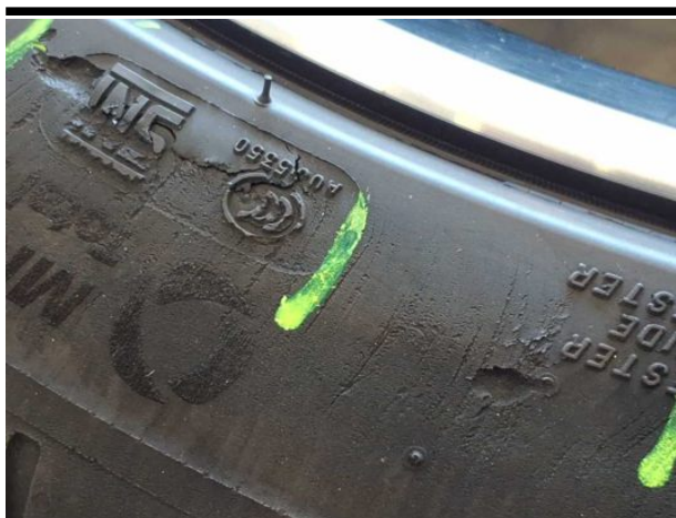
Beschädigung #5: 2.Radsatz: 1 Reifen - gebrochen / gerissen - erneuern
