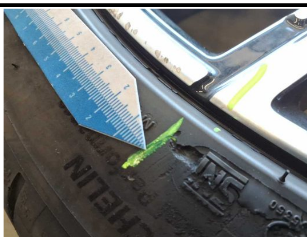
Beschädigung #5: 2.Radsatz: 1 Reifen - gebrochen / gerissen - erneuern
