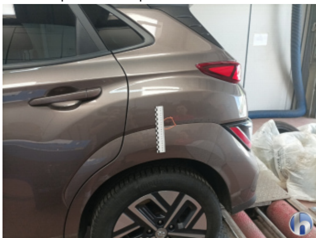
4. Seitenwand - Hinten - Links Delle - Sanft Instandsetzen
