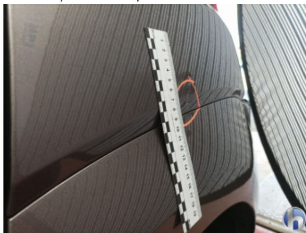
4. Seitenwand - Hinten - Links Delle - Sanft Instandsetzen
