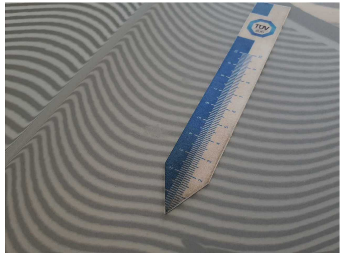
Damage 6: Bonnet: Bonnet (Anätzung) - Paint defect - Paint
