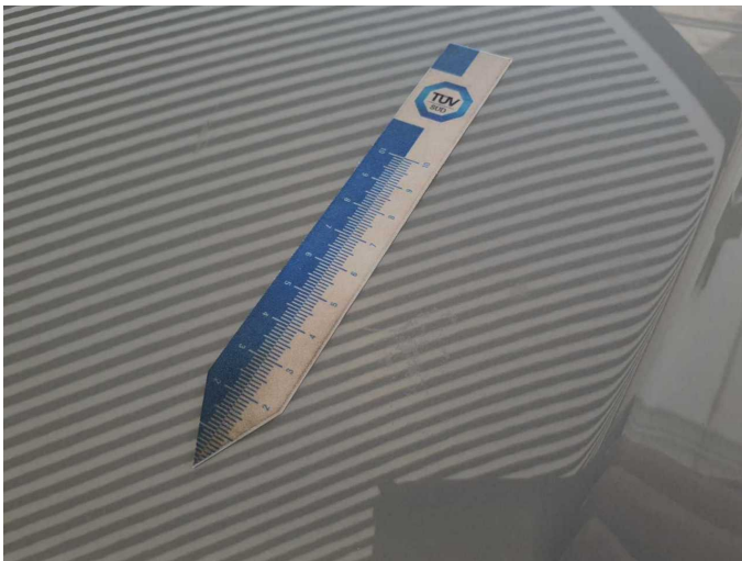
Damage 6: Bonnet: Bonnet (Anätzung) - Paint defect - Paint
