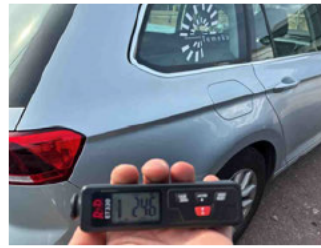
Lackstärke Seitenwand hinten rechts
