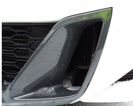
Grille de pare-chocs / Avant Gauche / Manquant
