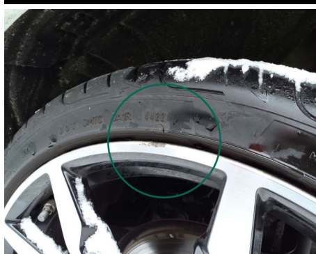
Pneu / Arrière Gauche / Déchiré
