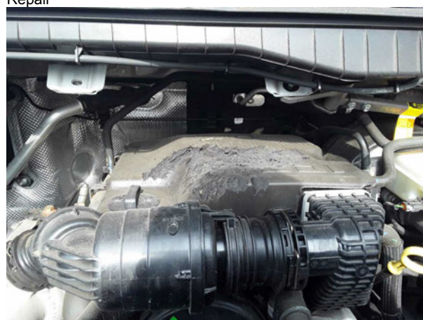
Beschädigung #2: Motor: Motorabdeckung (Maderschaden) - beschädigt - erneuern
