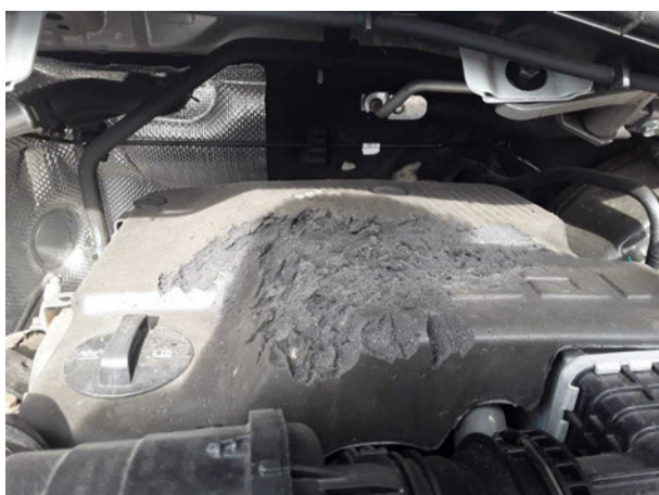
Beschädigung #2: Motor: Motorabdeckung (Maderschaden) - beschädigt - erneuern
