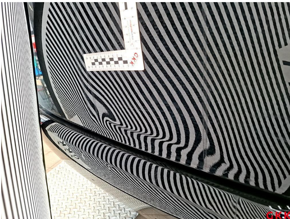
Bild 24. Heckklappe, beschädigt, instand setzen - lackieren
