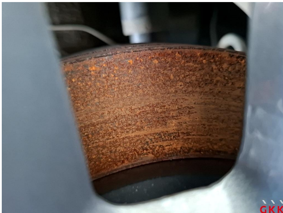
Bild 28. Bremsscheiben, komplett, korrodiert / Standschaden, ersetzen
