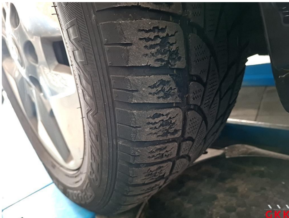
Bild 14. Reifen, vorn links und rechts, beschädigt, ersetzen
