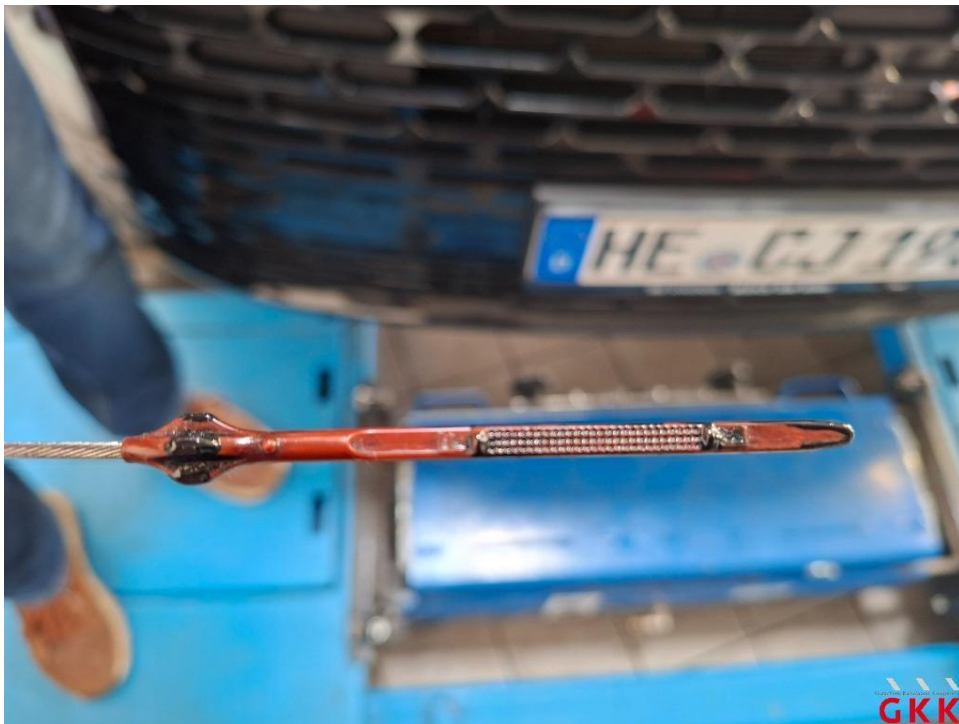
Bild 30. Motor, Motorölstand, unter Minimum, prüfen
