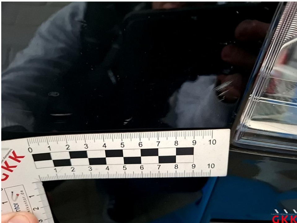
Bild 20. Stoßfänger vorne, Verkleidung -lackiert-, verkratzt, Smartrepair
