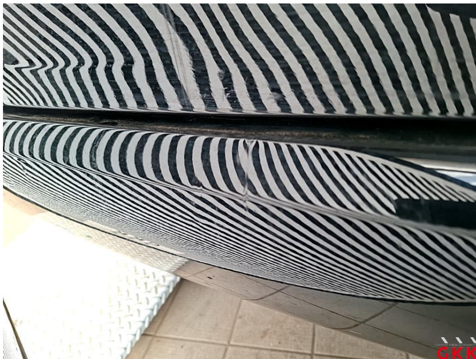
Bild 27. Stoßfänger hinten, Verkleidung -lackiert-, beschädigt, instand setzen - lackieren
