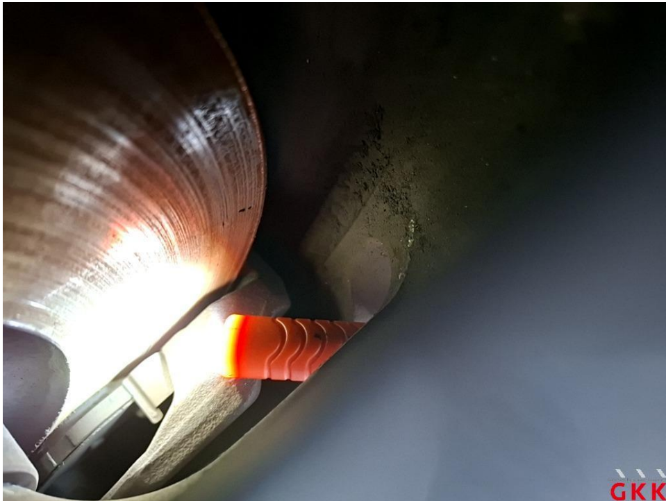
Bild 29. Bremsscheiben, komplett, korrodiert / Standschaden, ersetzen
