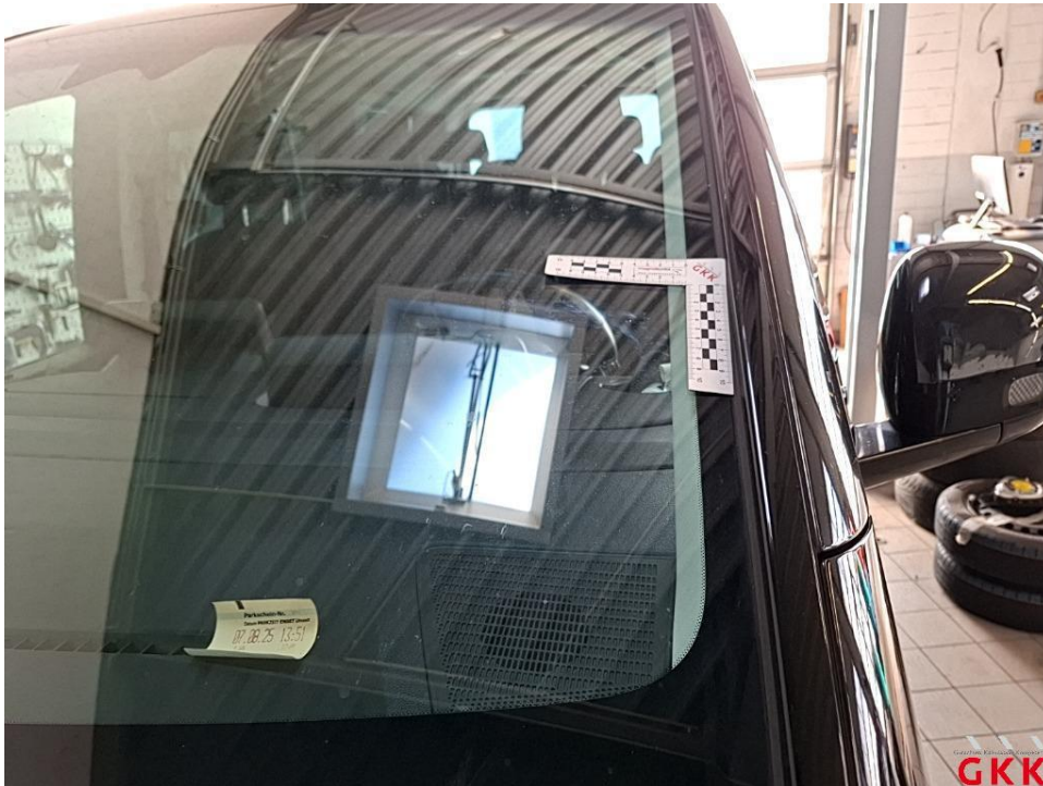
Bild 17. Frontscheibe, wärmedämmend mit Regensensor und Frontkamera, Steinschlag im Sichtfeld, ersetzen
