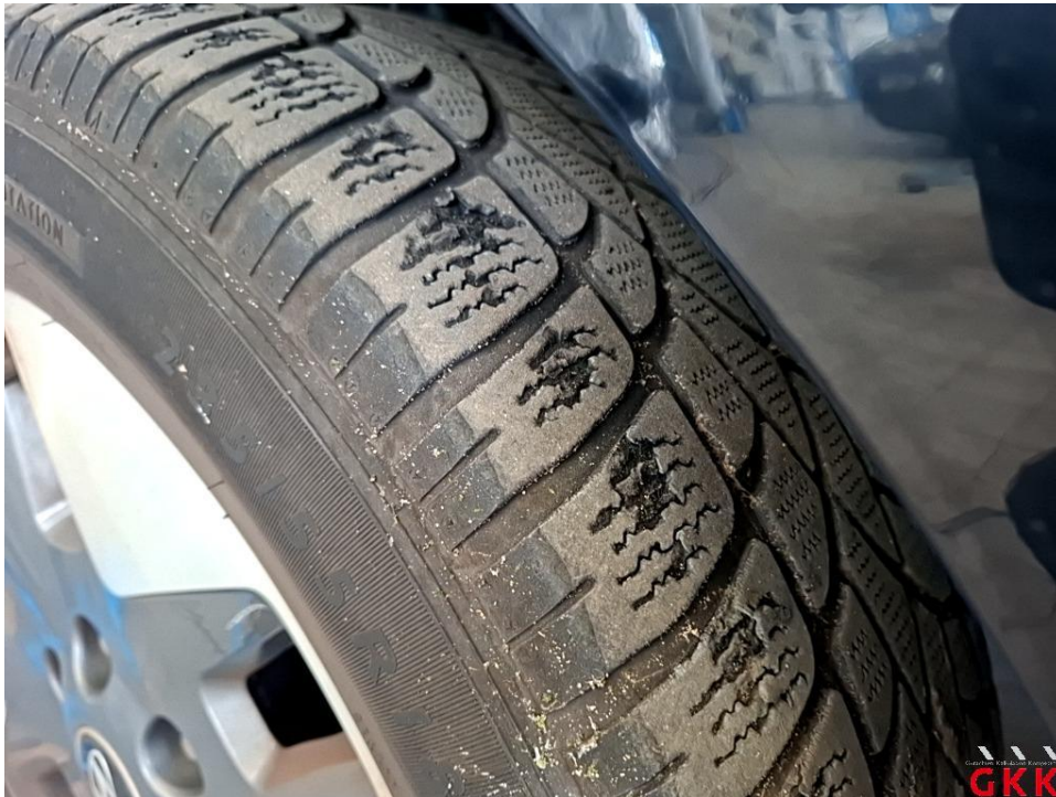
Bild 15. Reifen, vorn links und rechts, beschädigt, ersetzen
