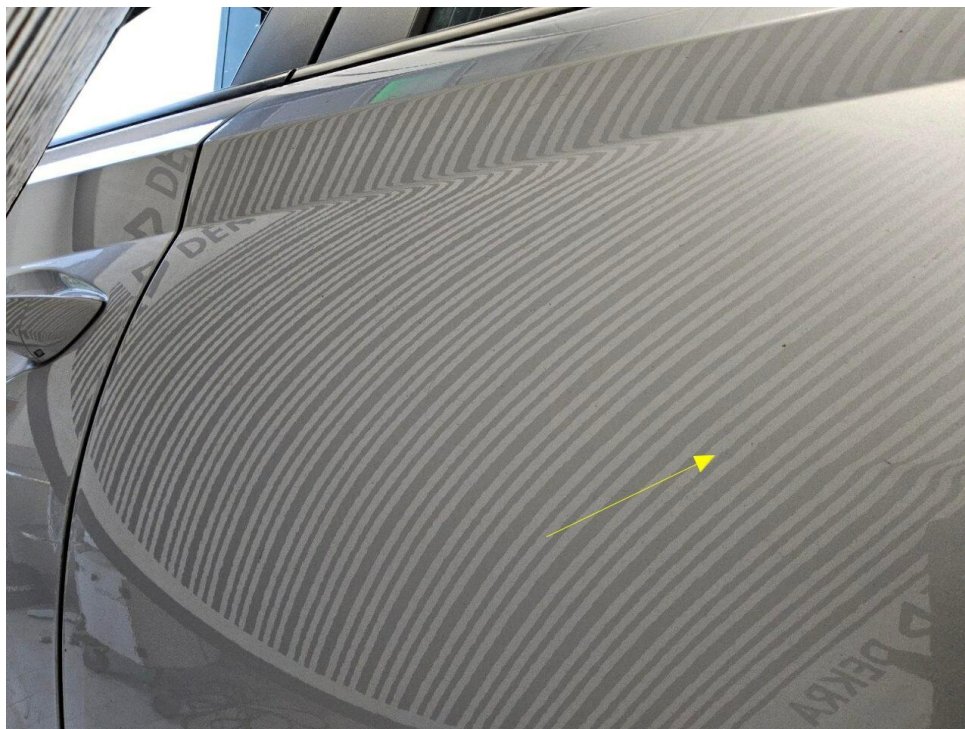
Bild 11 : Tür hinten links, eingedellt, Gebrauchsspur
