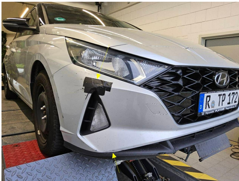
Bild 27 : Stoßfänger vorne deformiert
