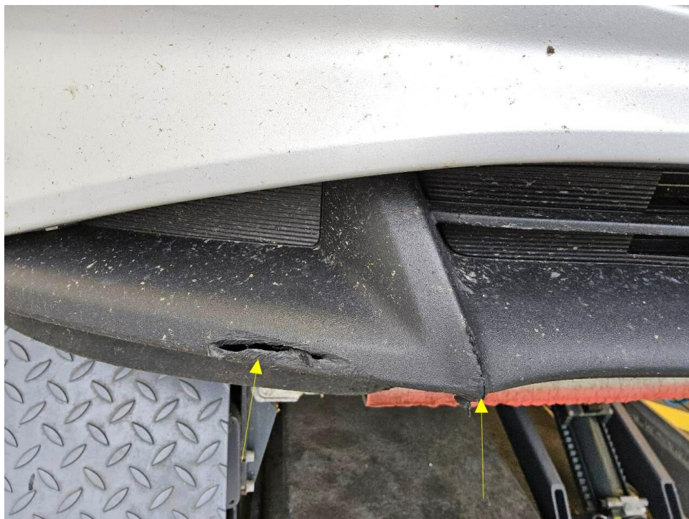
Bild 30 : Stoßfänger vorne, Spoiler gebrochen
