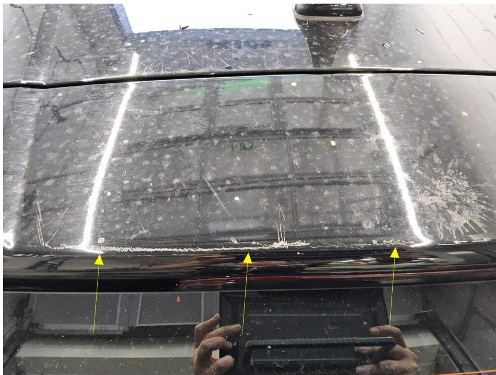
Bild 15 : Heckdeckel Lackierung, verschrammt, lackieren
