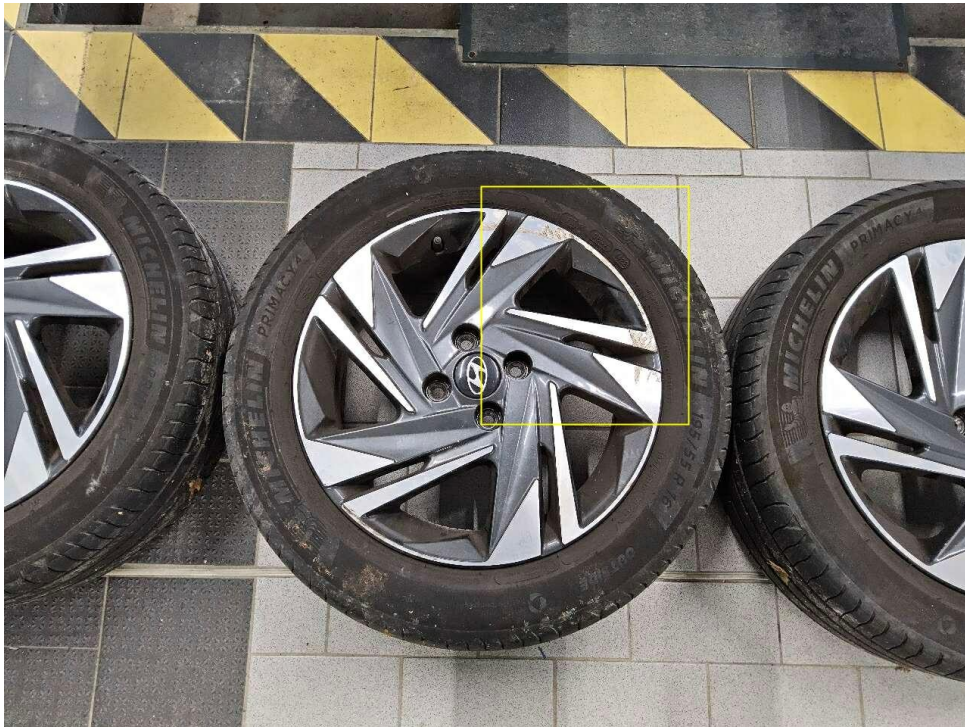
Bild 35 : Leichtmetallfelgen mit Sommerreifen verschrammt
