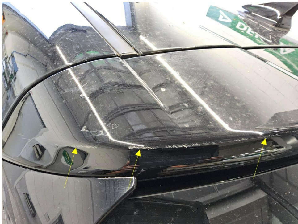
Bild 14 : Heckdeckel Lackierung, verschrammt, lackieren
