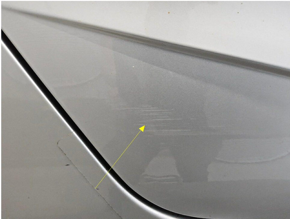
Bild 25 : Tür hinten rechts, mehrfach eingedellt, instandsetzen und lackieren mit Lackaufbau
