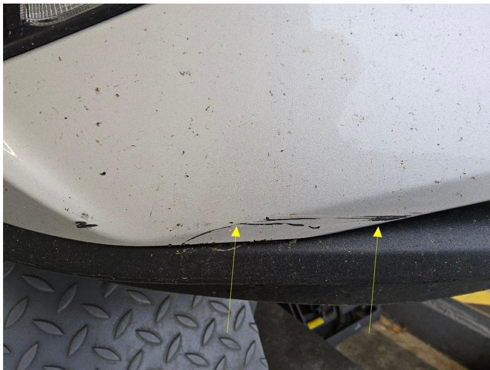
Bild 29 : Stoßfänger vorne deformiert
