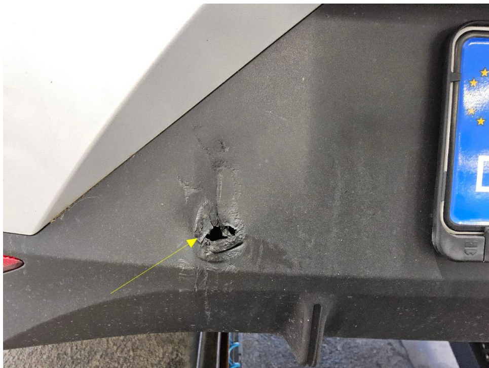
Bild 18 : Stoßfänger hinten deformiert
