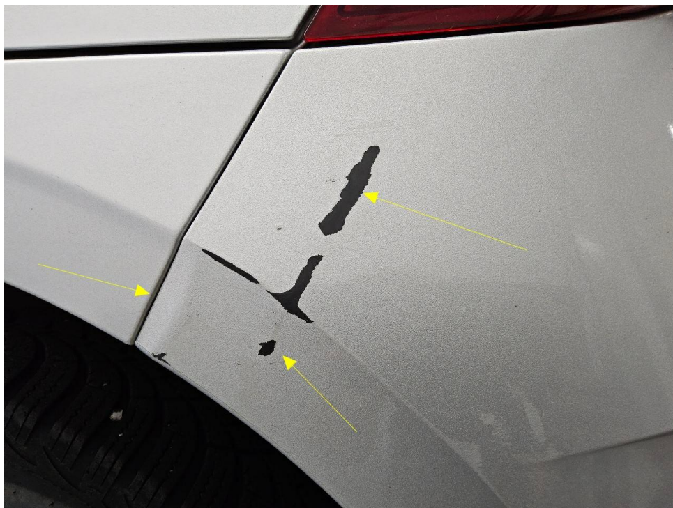
Bild 19 : Stoßfänger hinten deformiert
