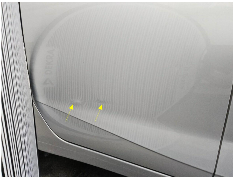
Bild 24 : Tür hinten rechts, mehrfach eingedellt, instandsetzen und lackieren mit Lackaufbau
