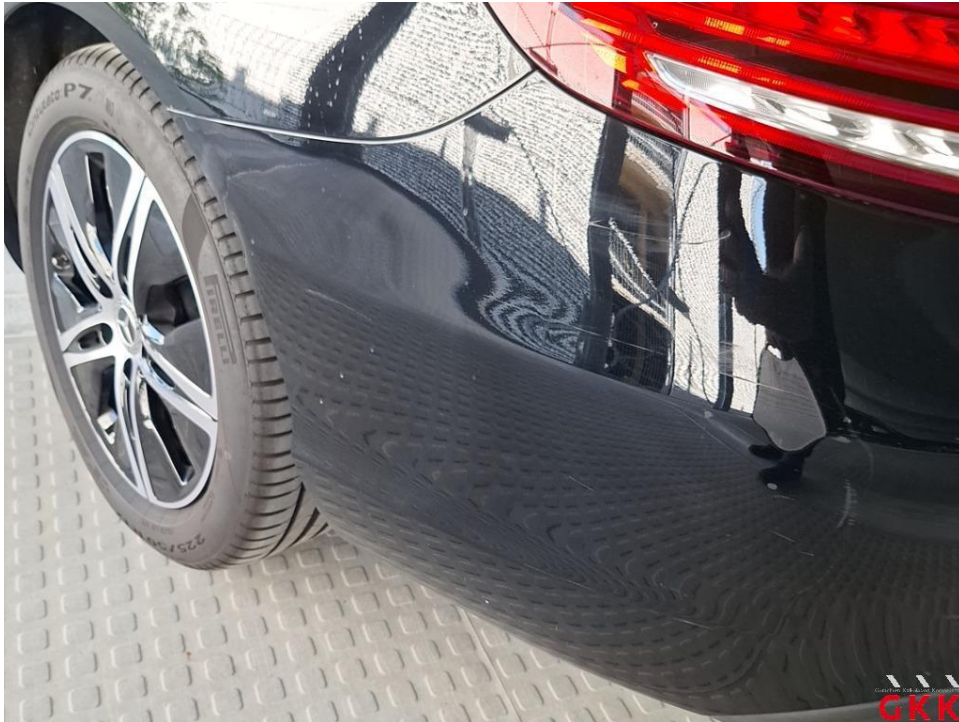
Bild 19. Stoßfänger hinten, Verkleidung -lackiert-, beschädigt, ersetzen
