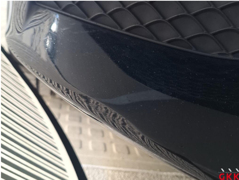
Bild 14. Stoßfänger vorne, Verkleidung -lackiert-, beschädigt, instand setzen - lackieren
