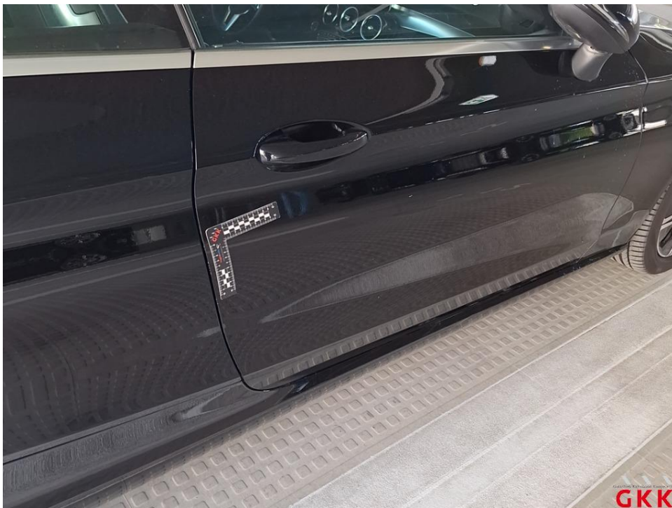
Bild 22. Tür vorne rechts, Kante, verkratzt, auslegen, schleifen, polieren
