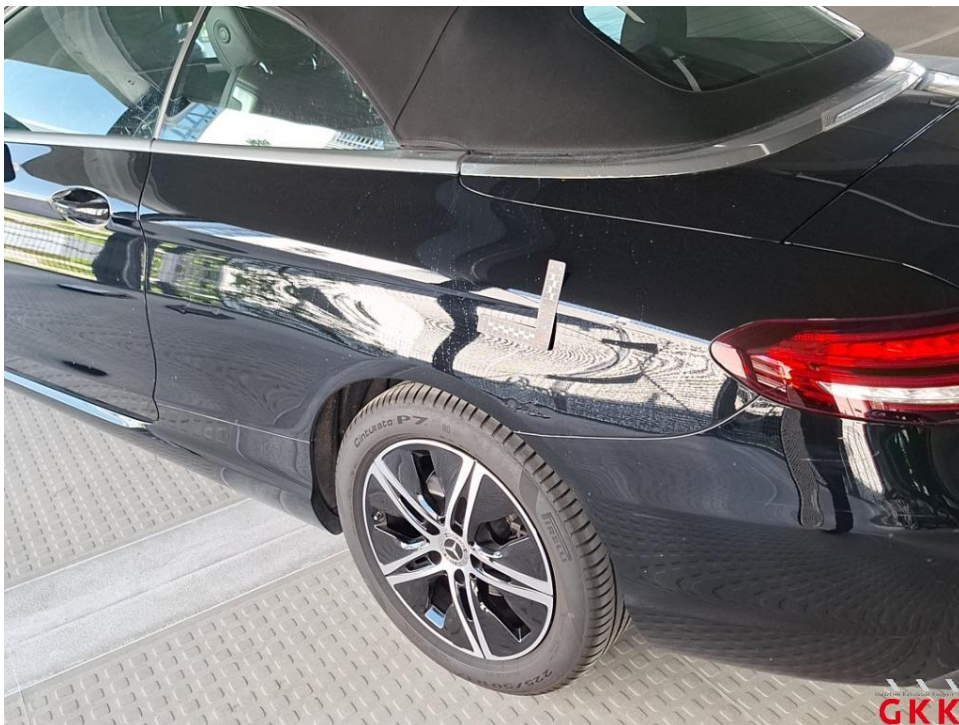
Bild 16. Seitenwand links, beschädigt, instand setzen - lackieren
