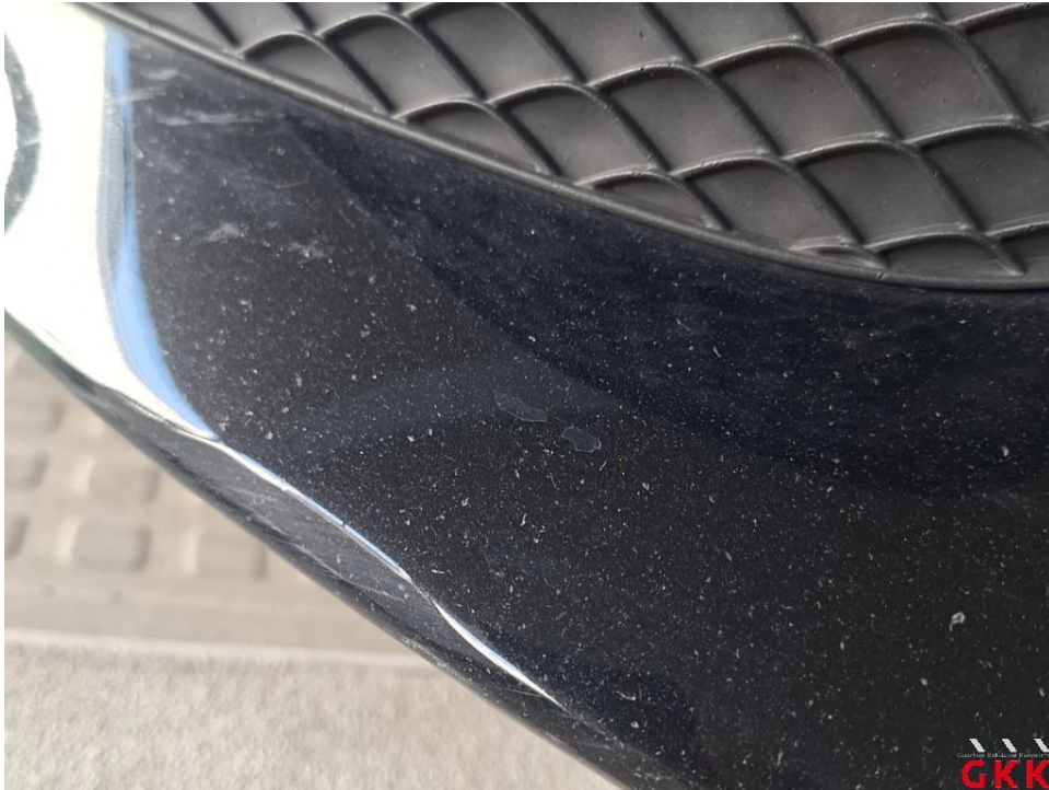
Bild 15. Stoßfänger vorne, Verkleidung -lackiert-, beschädigt, instand setzen - lackieren
