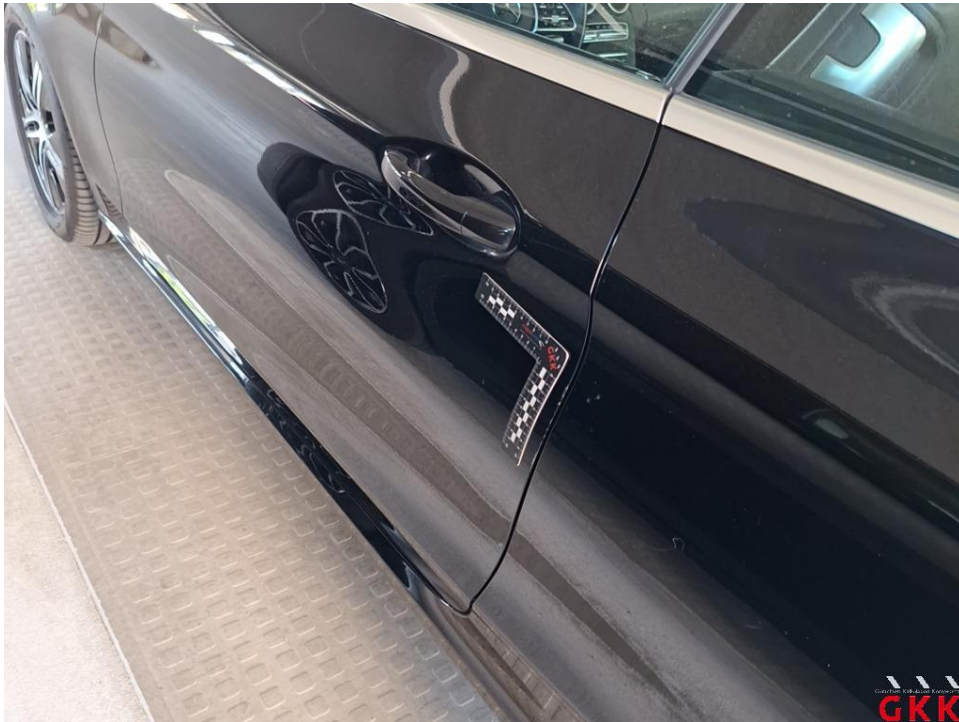
Bild 24. Tür vorne links, Kante, verkratzt, auslegen, schleifen, polieren
