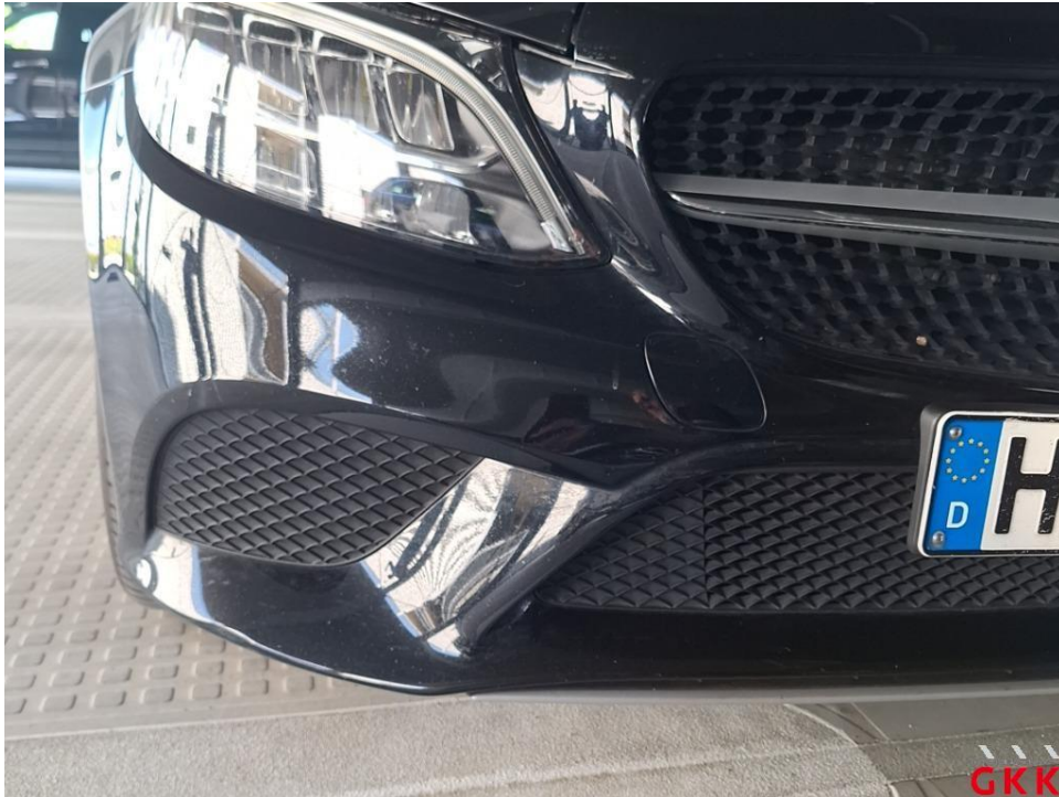
Bild 13. Stoßfänger vorne, Verkleidung -lackiert-, beschädigt, instand setzen - lackieren
