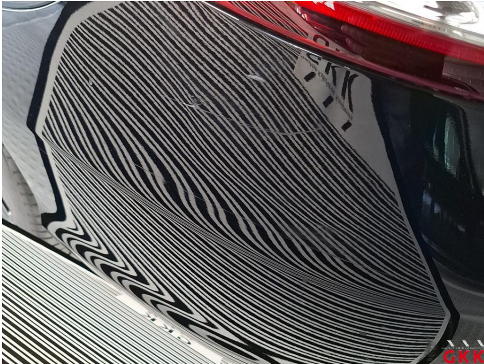
Bild 21. Stoßfänger hinten, Verkleidung -lackiert-, beschädigt, ersetzen
