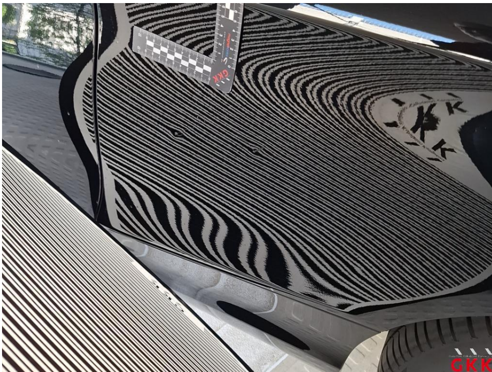
Bild 18. Seitenwand links, beschädigt, instand setzen - lackieren
