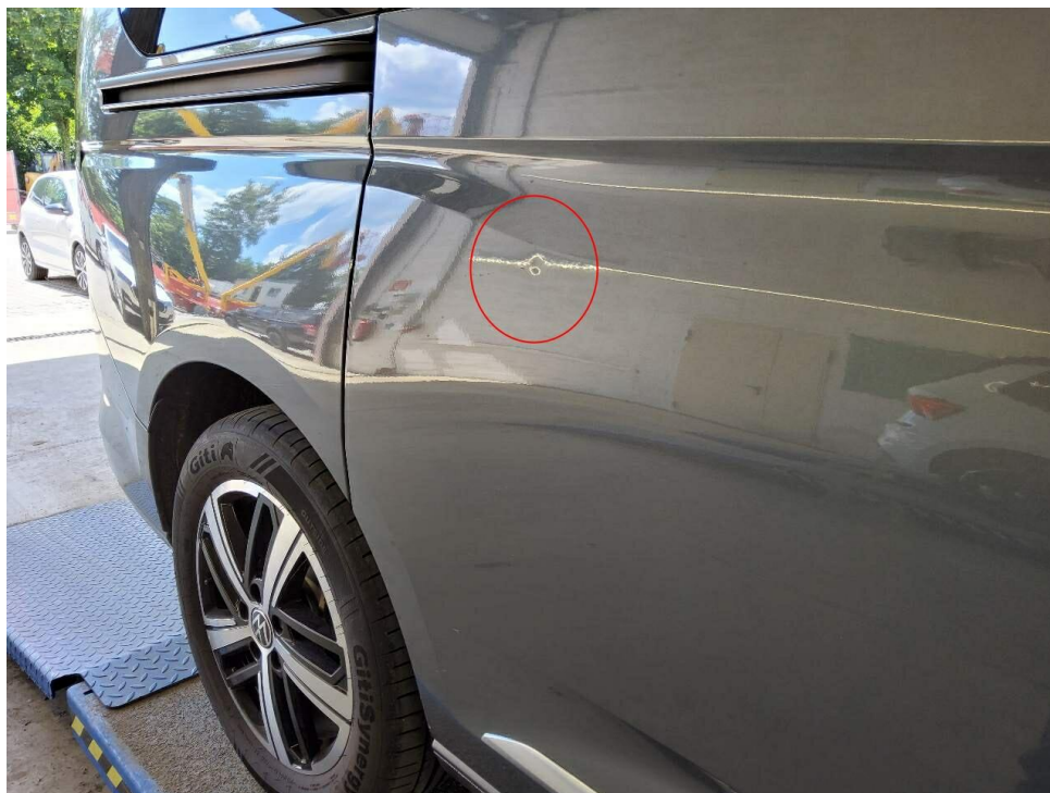
Bild 17 : Tür hinten rechts, eingedellt
