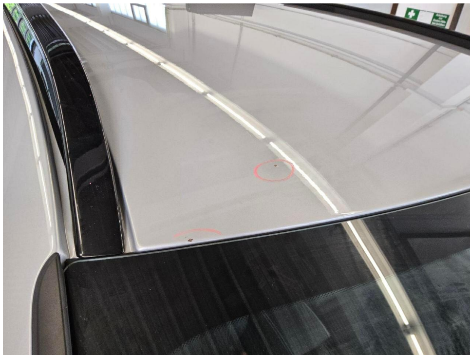
Bild 13 : Dach, korrodiert, lackieren mit Lackaufbau
