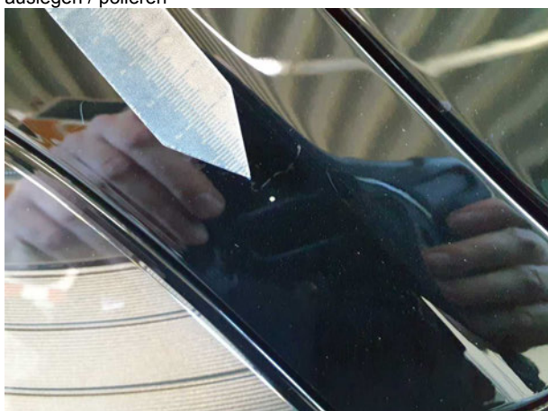
Beschädigung #1: Kotflügel rechts: Kotflügel rechts - Steinschlag - auslegen / polieren
