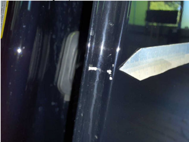
Beschädigung #4: Tür hinten links: Tür - verkratzt / verschürft - Smart Repair
