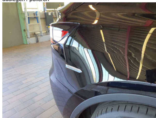
Beschädigung #2: Seitenwand rechts: Seitenwand - verkratzt / verschürft - auslegen / polieren
