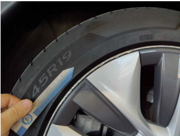
Beschädigung #6: Rad/Reifen: Leichtmetallfelge hinten rechts - verkratzt / verschürft - erneuern
