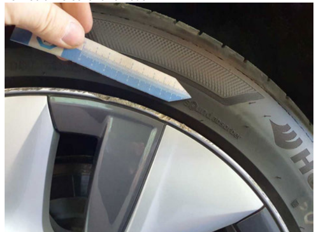
Beschädigung #5: Rad/Reifen: Leichtmetallfelge hinten links - verkratzt / verschürft - erneuern
