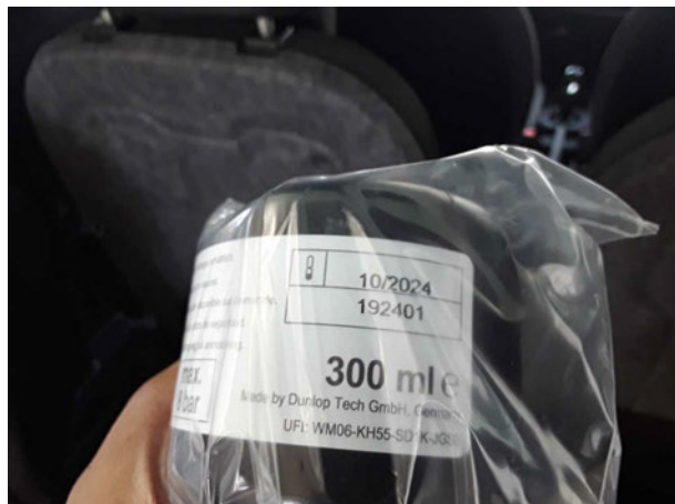
Beschädigung #1: Ausrüstung: Tirefit Füllmittel - abgelaufen - erneuern
