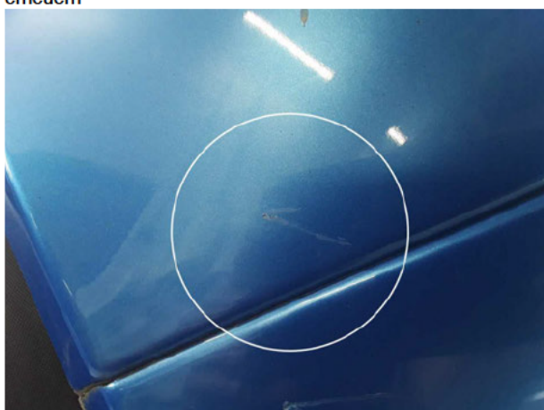
Beschädigung #5: Seitenwand links: Seitenwand - verkratzt / verschürft - lackieren
