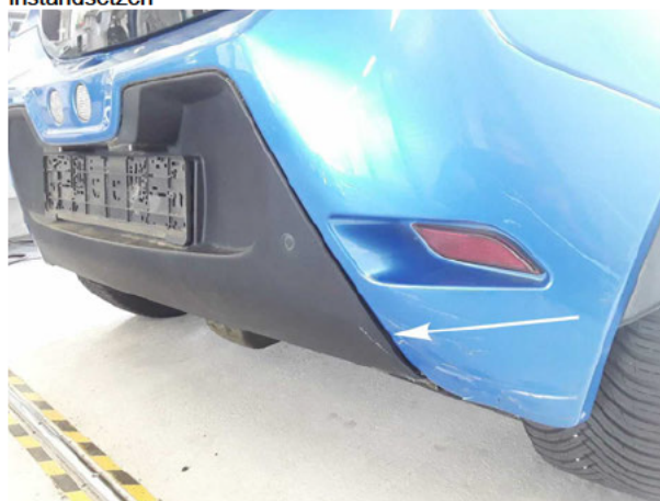
Beschädigung #4: Stossfänger hinten: Spoiler - verkratzt / verschürft - erneuern
