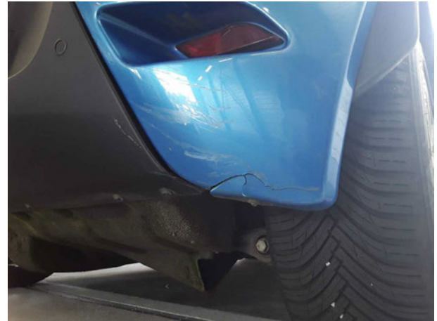
Beschädigung #6: Stossfänger hinten: Stossfänger hinten - gebrochen / gerissen - erneuern
