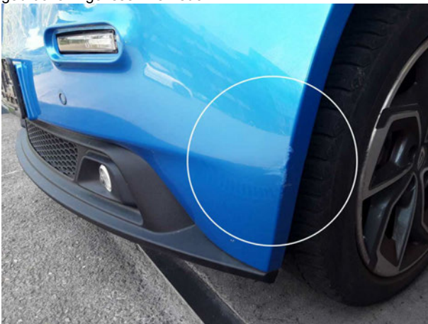
Beschädigung #7: Stossfänger vorn: Stossfänger vorn - gebrochen / gerissen - erneuern
