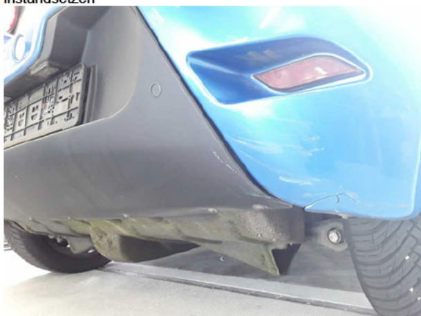
Beschädigung #4: Stossfänger hinten: Spoiler - verkratzt / verschürft - erneuern
