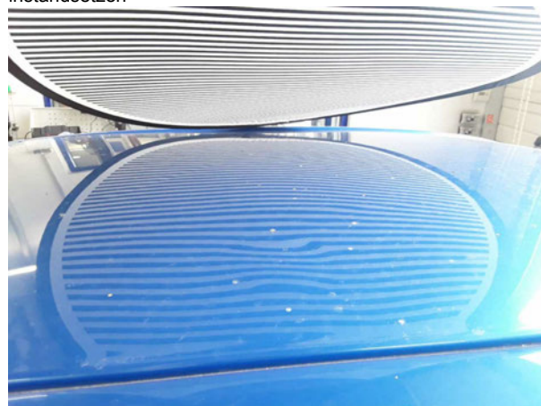
Beschädigung #3: Fahrzeugdach: Dach - Delle(n) - sanft instandsetzen
