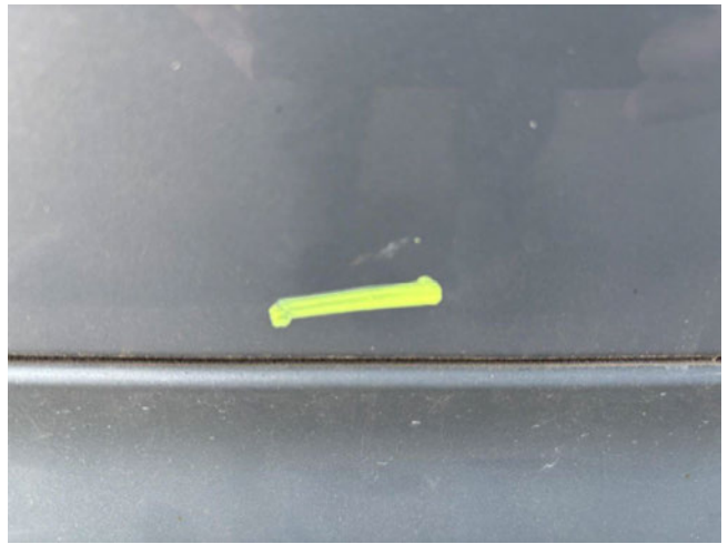
Stoßfänger hinten - Kratzer - polieren
