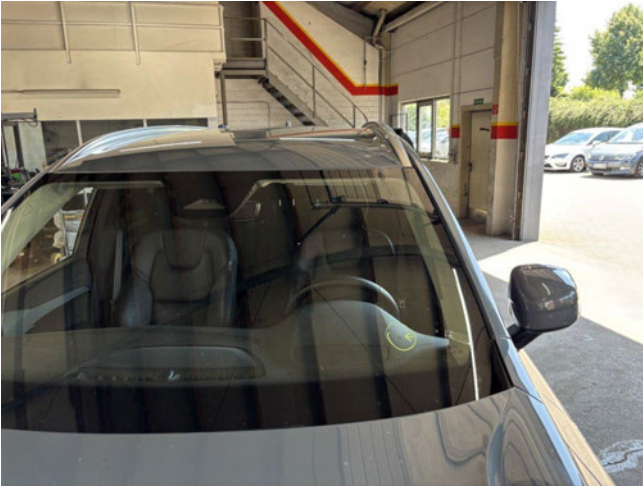
Windschutzscheibe - Steinschlag im Fahrersichtfeld - erneuern (Regensen.)
