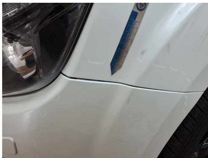
Damage 6: Front bumper: Front bumper (gerissen, schlecht lackiert, Fehlstellung) - Unprofessionally repaired - Replace
