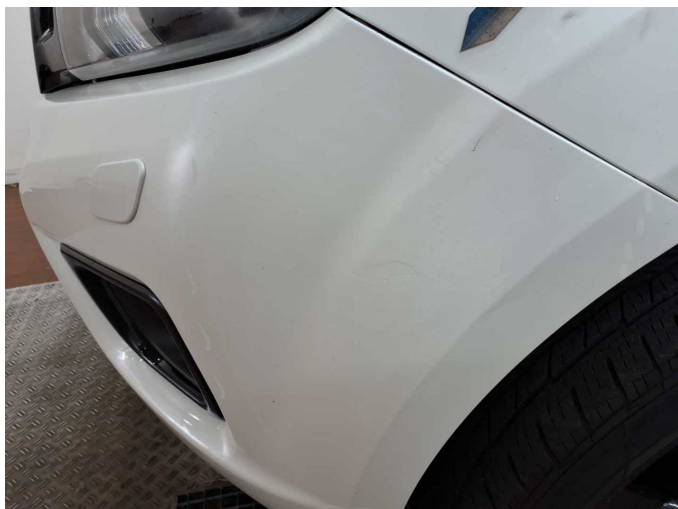
Damage 6: Front bumper: Front bumper (gerissen, schlecht lackiert, Fehlstellung) - Unprofessionally repaired - Replace
