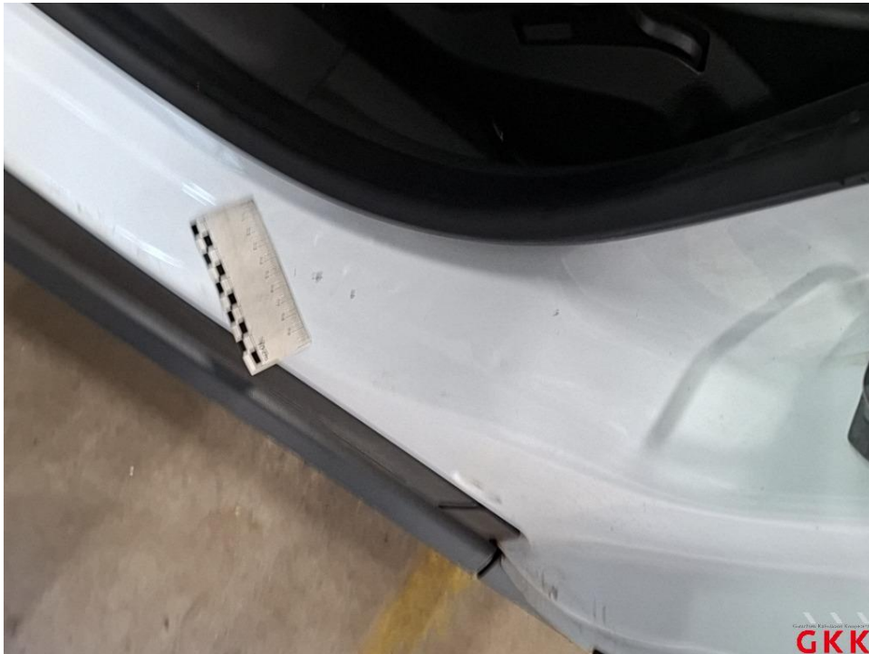
Bild 21 Tür vorne links, Einstieg, beschädigt, Smartrepair
