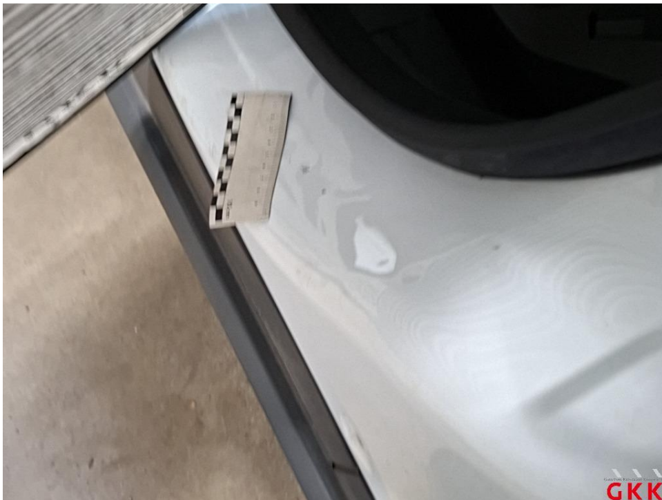
Bild 22 Tür vorne links, Einstieg, beschädigt, Smartrepair
