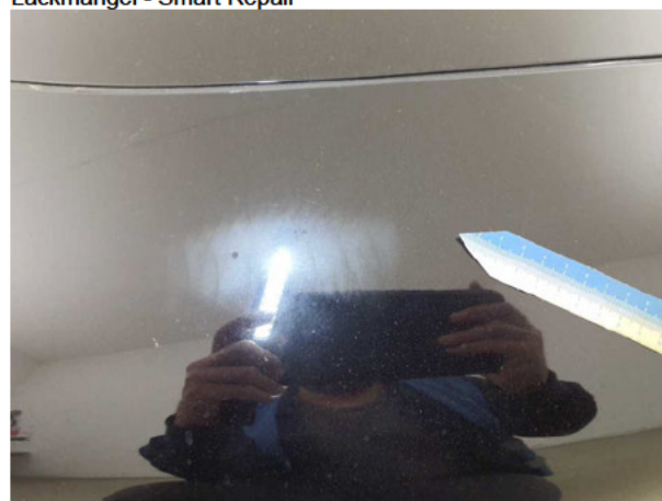
Beschädigung #4: Stossfänger vorn: Stossfänger vorn - Lackmangel - Smart Repair
