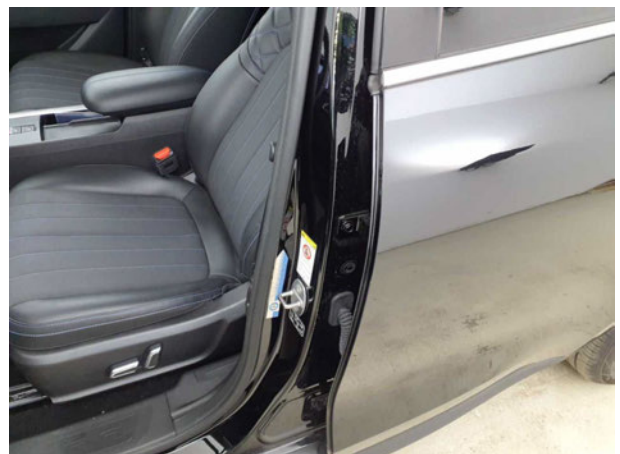
Beschädigung #3: Karosserie: B-Säule links - Delle(n) - Smart Repair
