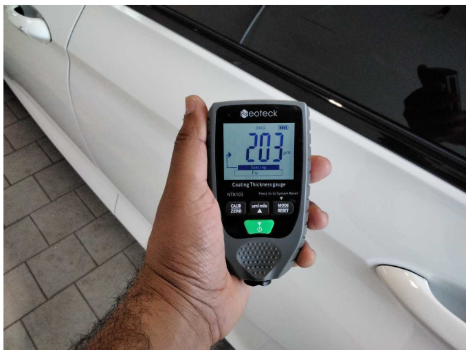
Door - rear left side: 203 µm
