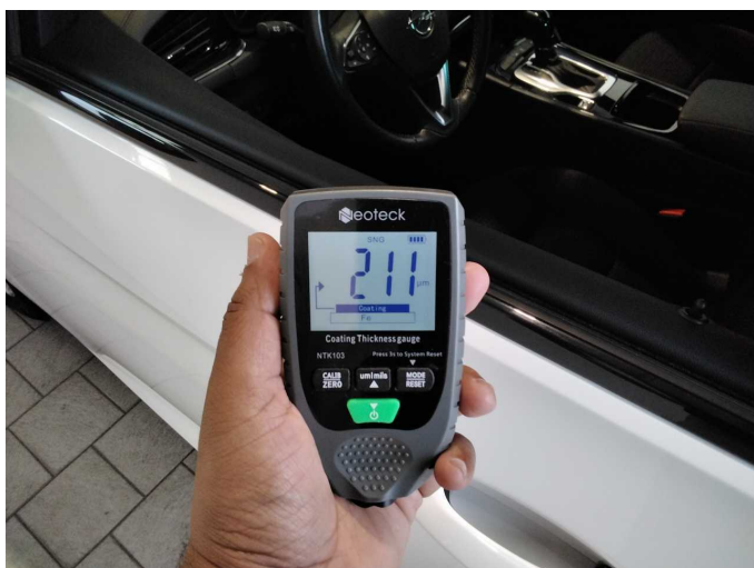
Door - front left side: 211 µm
