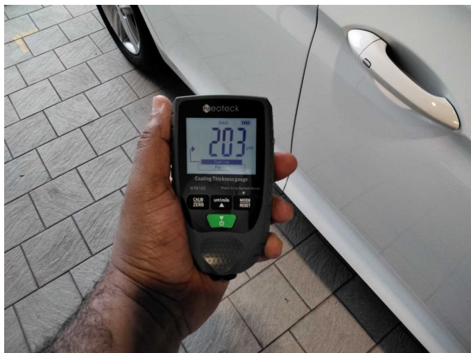
Door - front right side: 203 µm
