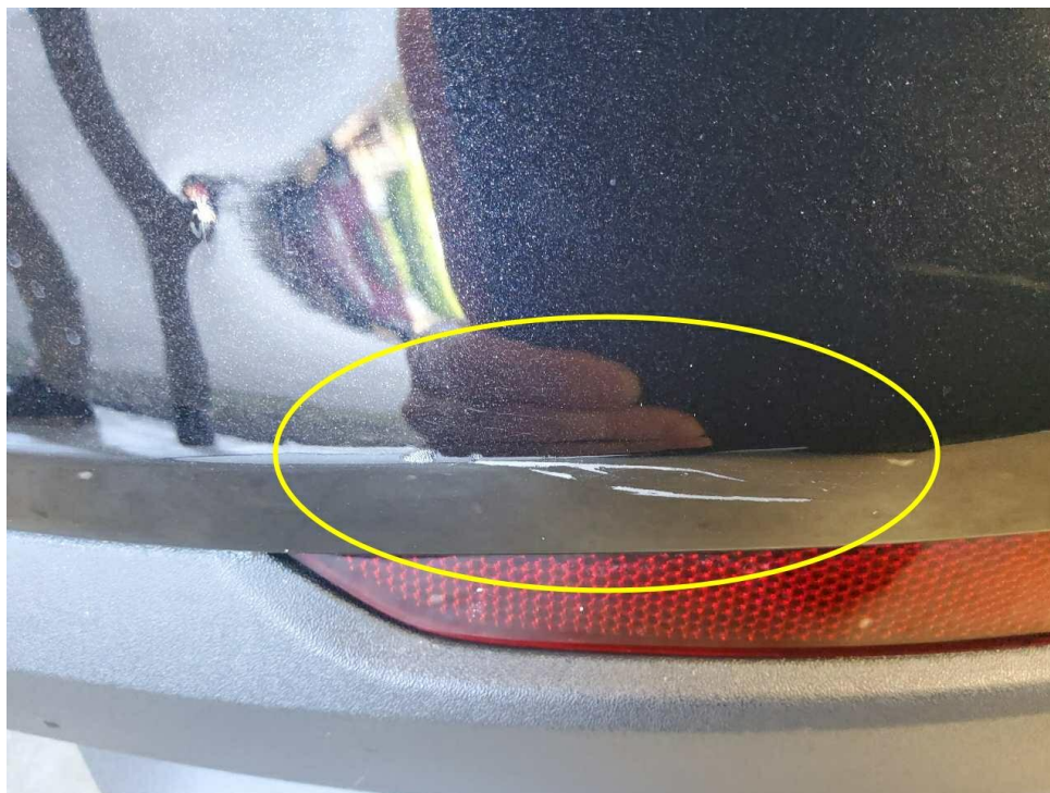
Bild 19 : Stoßfänger hinten deformiert-zerkratzt
