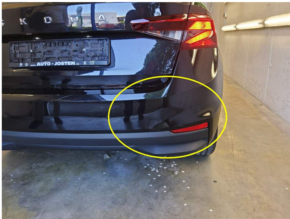
Bild 17 : Stoßfänger hinten deformiert-zerkratzt
