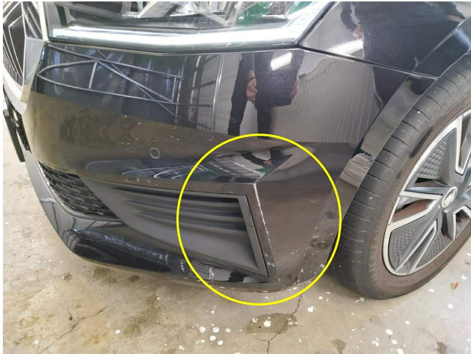
Bild 15 : Stoßfänger vorne Lackierung, zerkratzt, lackieren mit Lackaufbau
