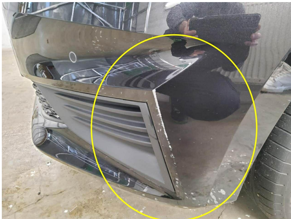
Bild 14 : Stoßfänger vorne Lackierung, zerkratzt, lackieren mit Lackaufbau
