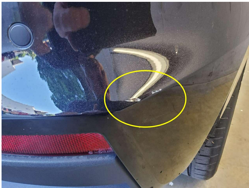
Bild 20 : Stoßfänger hinten deformiert-zerkratzt
