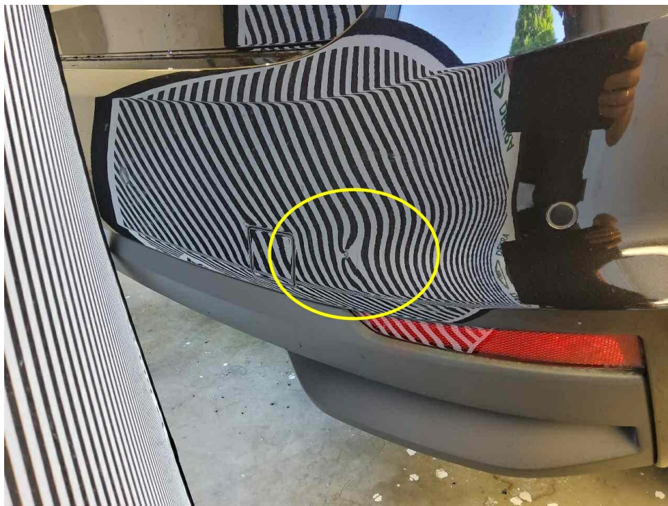
Bild 18 : Stoßfänger hinten deformiert-zerkratzt
